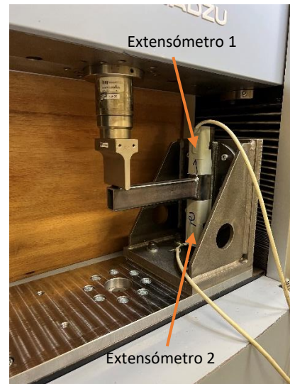
Figura 62-Ensaio de flexão de junta com instrumentação
