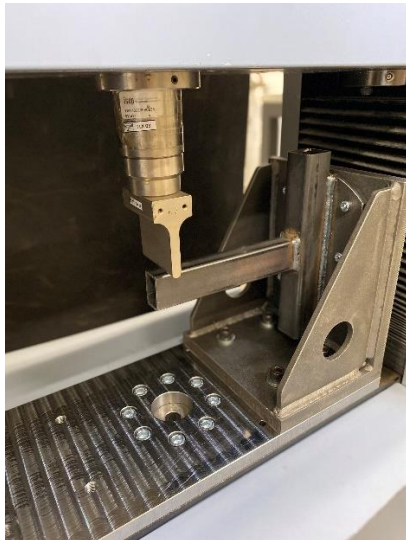
Figura 61-Ensaio de flexão de junta sem instrumentação
