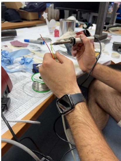
Figura 46-Estanhagem dos fios elétricos
