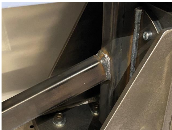
Figura 64-Junta após ensaio (Ensaio de flexão com junta não instrumentada)
