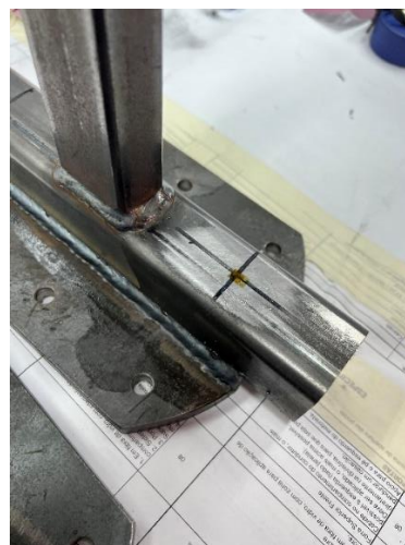
Figura 45-Extensómetro aplicado na junta
