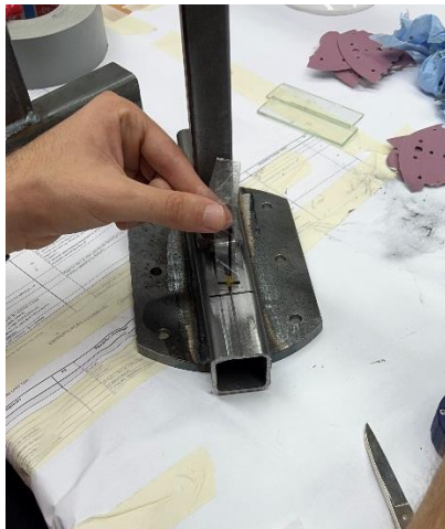
Figura 43-Processo de colagem do extensómetro (Descolagem da fita-cola e aplicação de cola)
