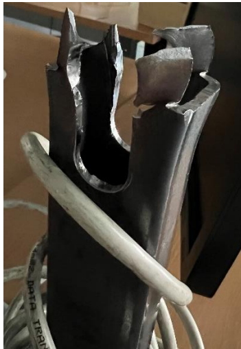
Figura 59-Zona de rotura (Ensaio de tração)
