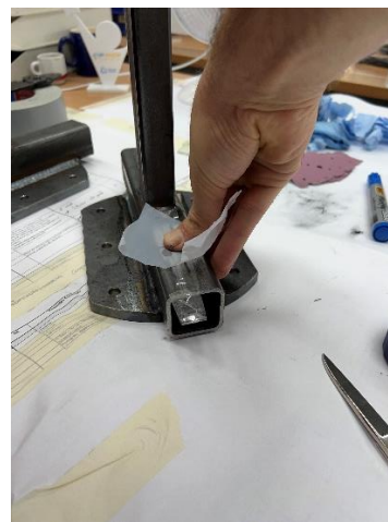
Figura 44-Processo de colagem do extensómetro (Pressão)
