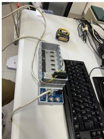
Figura 51-Conexão fios elétricos ao módulo NI 9235
