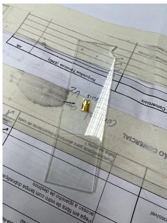
Figura 41-Extensómetro colocado em uma placa de vidro
