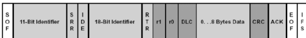
Figura 9 – Mensagem CAN da versão 2.0B (Extended CAN) [28]
