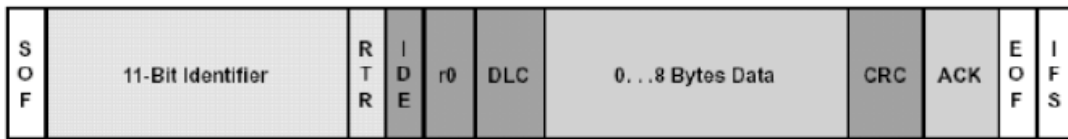
Figura 8 – Mensagem CAN da versão 2.0A (Standard CAN) [28]
