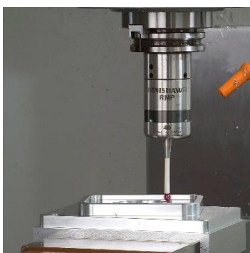
Figura 21 - Medição durante o processo num centro de maquinação vertical [23]
