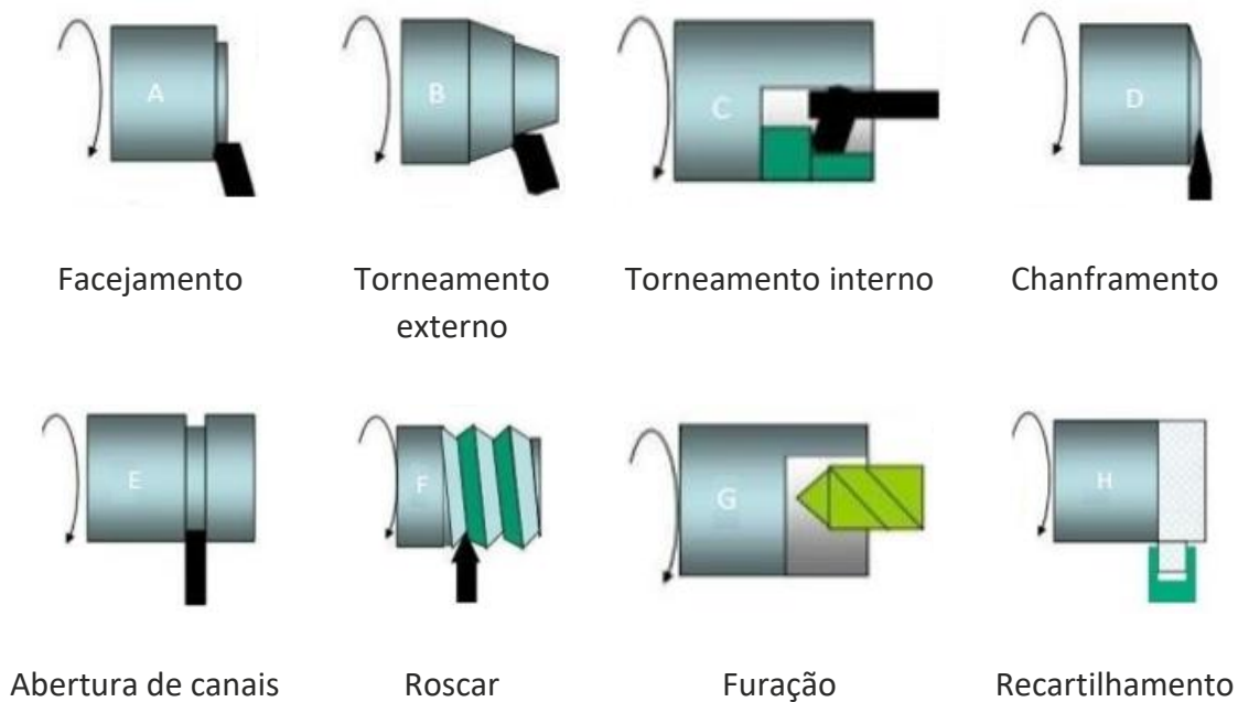
Figura 73 - Principais operações de torneamento
