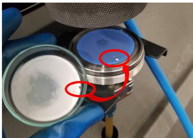
Figura 23 - Perda de massa devido ao rasgo da membrana.
