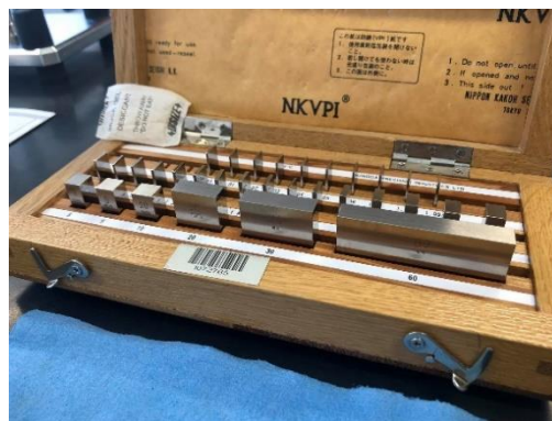
Figura 73 - Blocos padrão utilizados na calibração do paquímetro.
