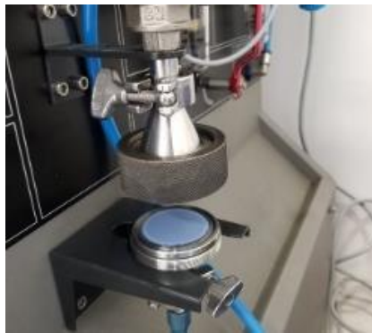
Figura 8 - Localização da membrana de nitrato de celulose no banco de ensaio CTU.
