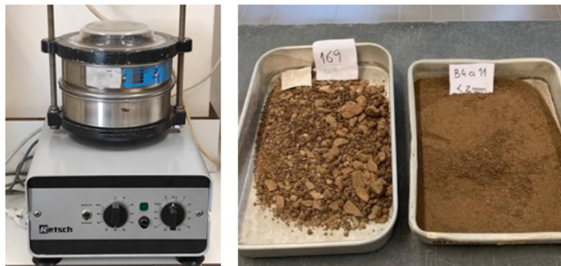
Figura 14. Processo de peneiração do solo e separação das duas frações granulométricas.
