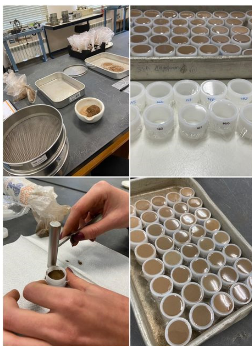
Figura 16. Preparação dos provetes para análise química elementar simplificada.
