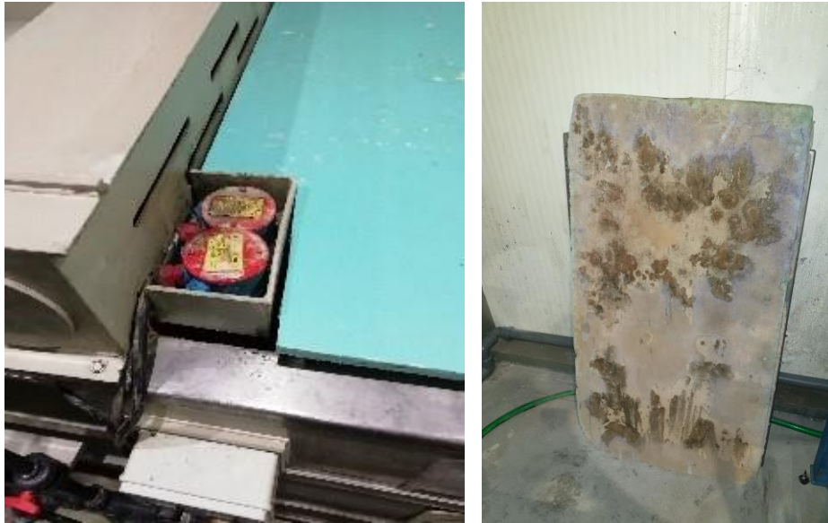
Figura 22 - Tampo em poliestireno (a) quando foi aplicado e (b) estado atual
