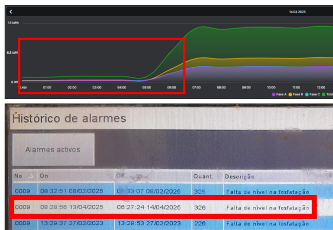
Figura 33 - Falha no aquecimento devido à falta de solução durante a noite
