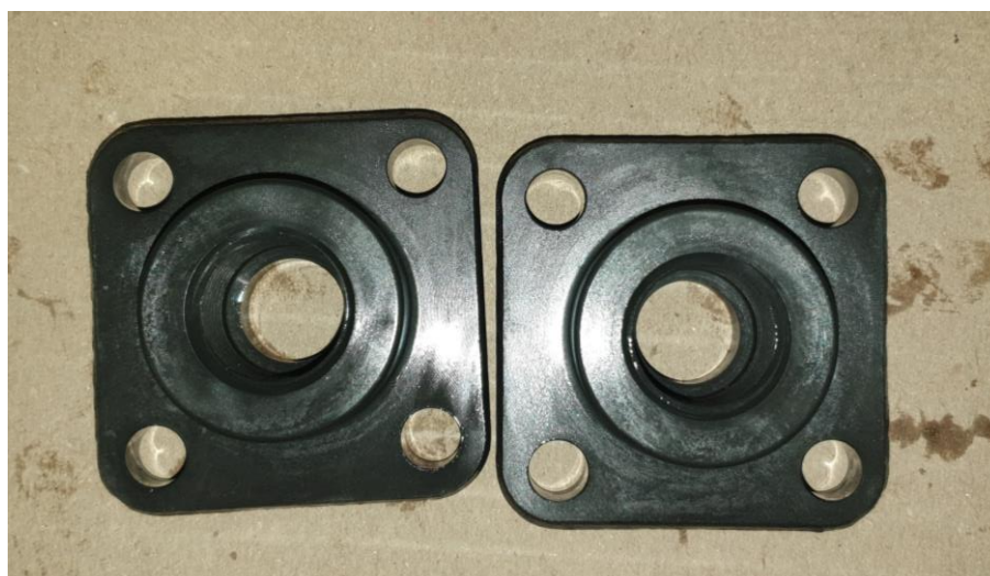
Figura 27 - Terminais mal fosfatados devido à baixa temperatura do banho
