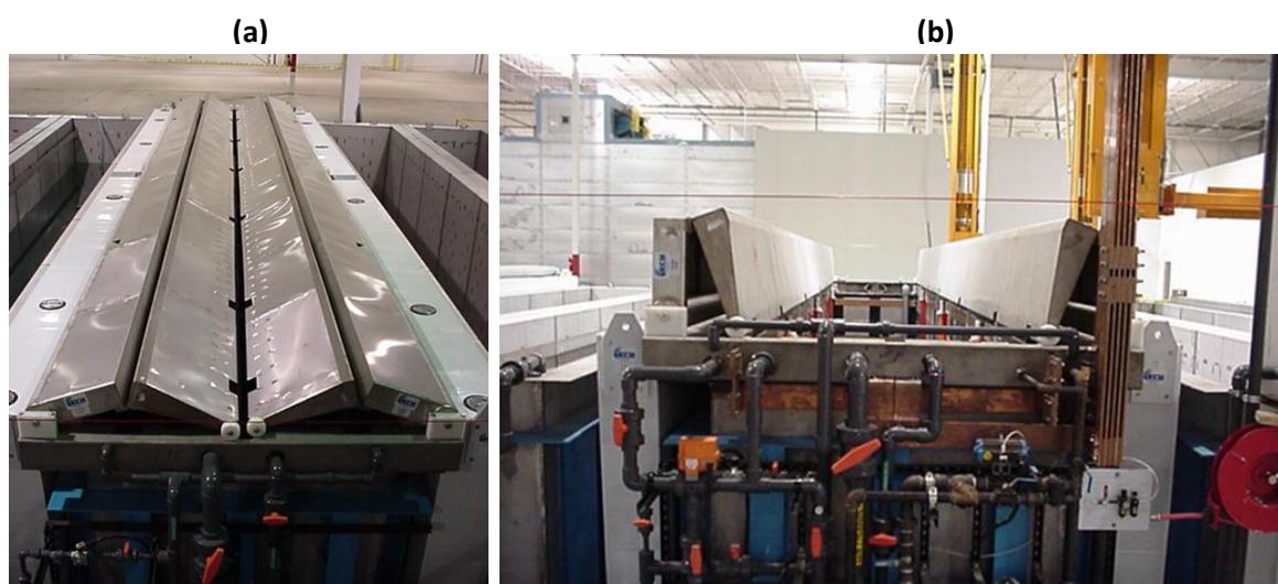
Figura 21 - Sistema ACTSEC da KCH (a) fechado e (b) aberto (KCH, 2011)
