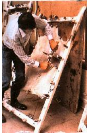
FIGURA 2.5.: RASPAGEM DE UMA PELE. (UP, 2008)
