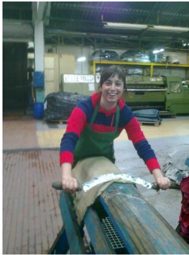
FIGURA 4.3: DESCARNA MANUAL DE UMA PELE.
