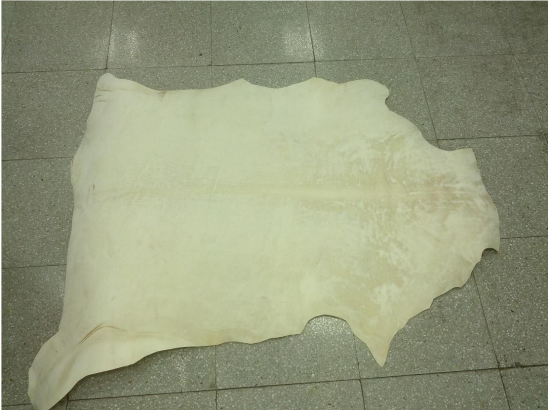
FIGURA 4.11: PELE ESTABILIZADA COM UM AGENTE LIVRE DE CRÓMIO.
