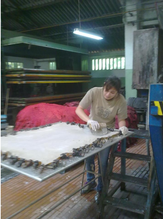
FIGURA 4.5: PELE A SER RASPADA.
