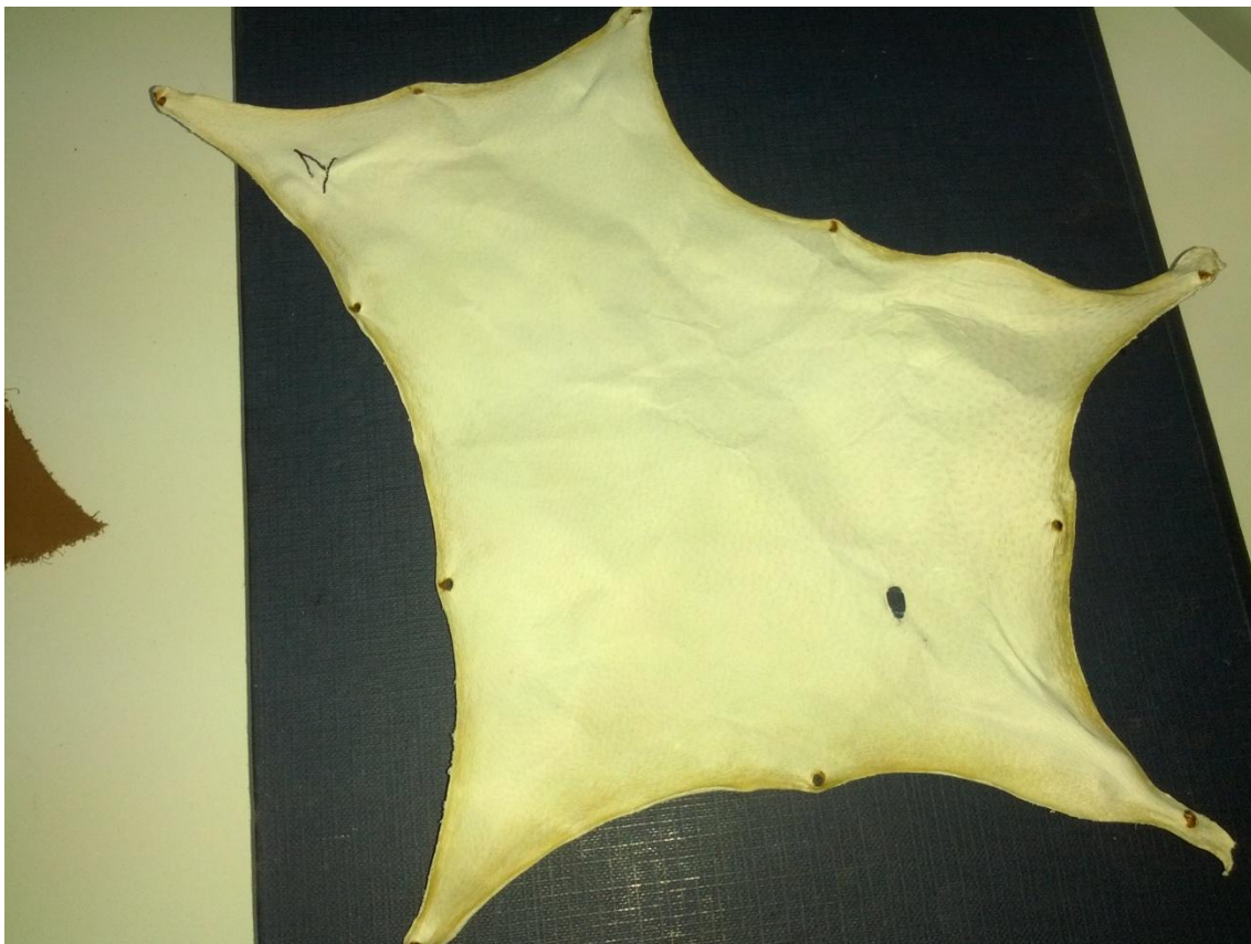
FIGURA 4.14.: PELE PIQUELADA PELE MÉTODO TRADICIONAL.
