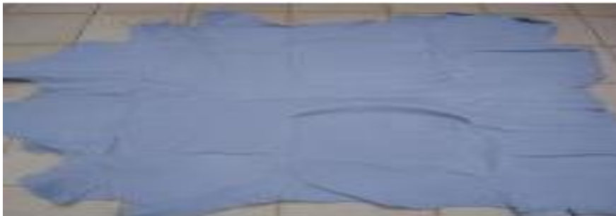
FIGURA 2.2: PELE EM WET-BLUE (BRAMER INTERNATIONAL).
