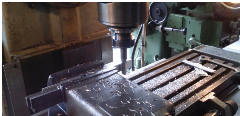
Figura 21 - Maquinagem da junta de chanfro interior com \alpha=3,43^\circ .
