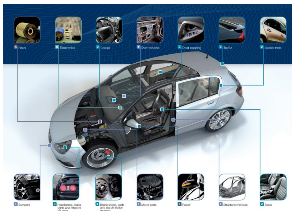
Figura 5 - Utilização das ligações adesivas na indústria automóvel [10].
