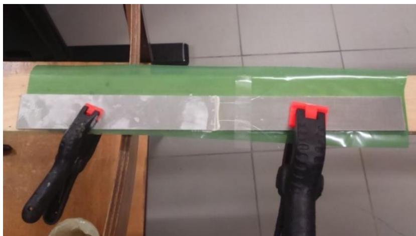
Figura 24 - Grampos para garantir a fixação da junta durante a cura.
