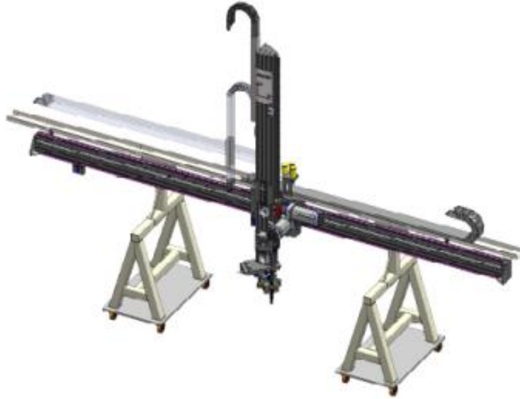
Figura 112 - Movimentação em plano de um pórtico
