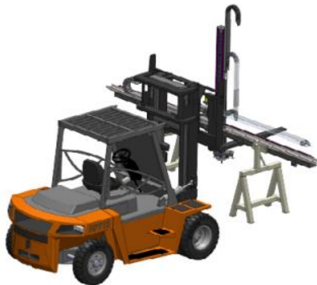
Figura 111 - Carga e descarga de um pórtico
