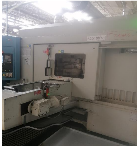
Figura 53 - Máquina TAMS para Shaving
