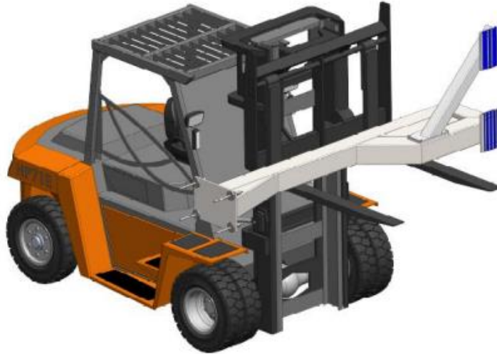
Figura 114 - Carga, descarga e movimentação em plano de um pilar
