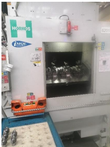
Figura 51 - Máquina Horkos para furação
