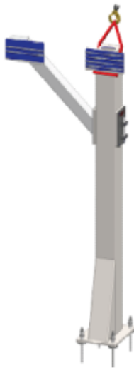
Figura 115 - Movimentações em altura dos pilares
