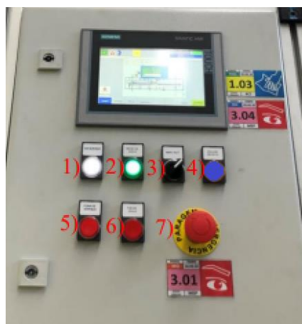
Figura 78 – Numeração dos botões na representação do comando local real
