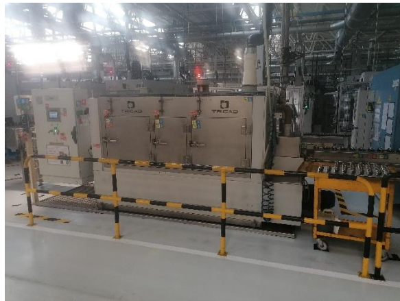
Figura 54 - Máquina TRICAD para lavagem, sopragem e secagem
