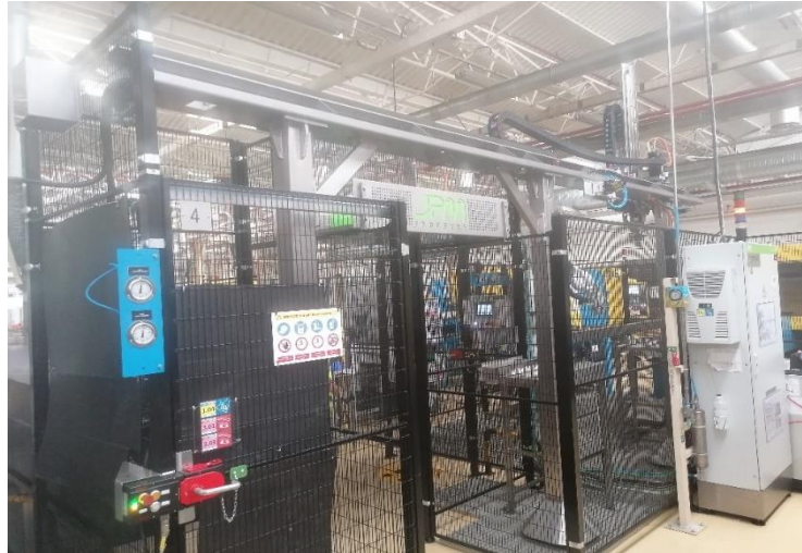
Figura 37 - Exemplo pórtico JPM na Renault Cacia
