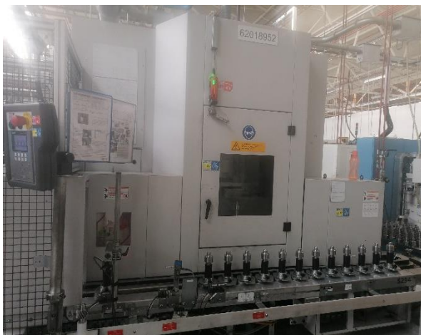
Figura 46 - Máquina LIEBHERR de talhagem e chanfragem
