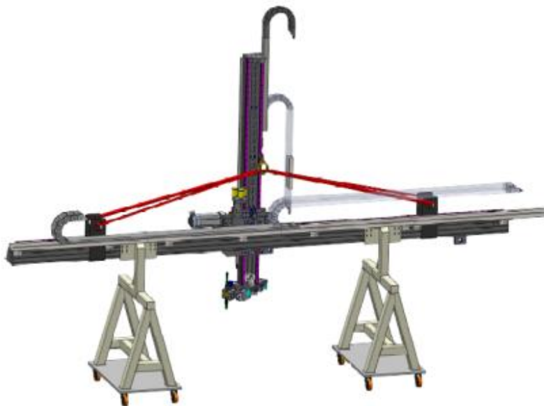
Figura 113 - Movimentações em altura de um pórtico
