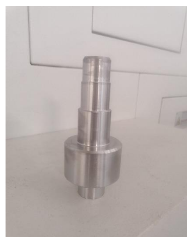
Figura 41 - ASH após processo de torneamento e acabamento
