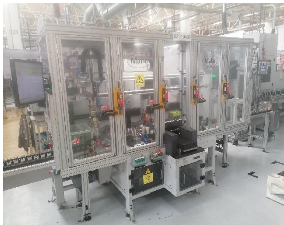
Figura 44 - Máquina Mahr onde é efetuado o controlo e marcação
