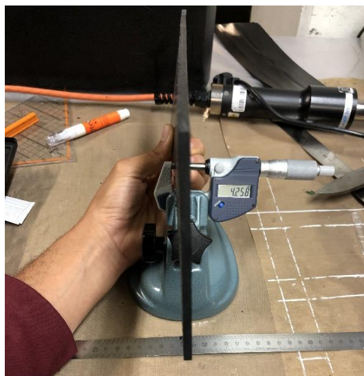
Figura 35 - Utilização do micrómetro para medição da espessura do blank
