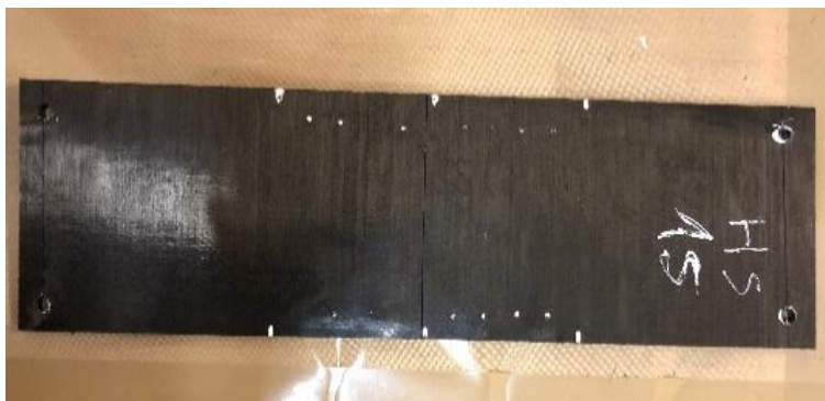
Figura 37 - Blank com furações e preparado para estampagem
