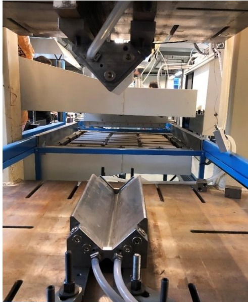
Figura 40 - Moldes utilizados no processo de estampagem a quente com as manguейras utilizadas para o controlo de temperatura
