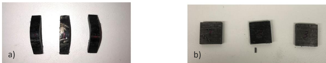
Figura 52 – Amostras para o ensaio de queima: a) amostras do raio e b) amostras das abas
