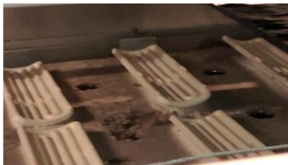
Figura 41 - Lâmpadas utilizadas no aquecimento do blank
