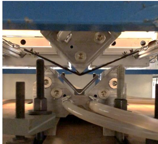
Figura 45 - Estampagem do blank com recurso à prensa
