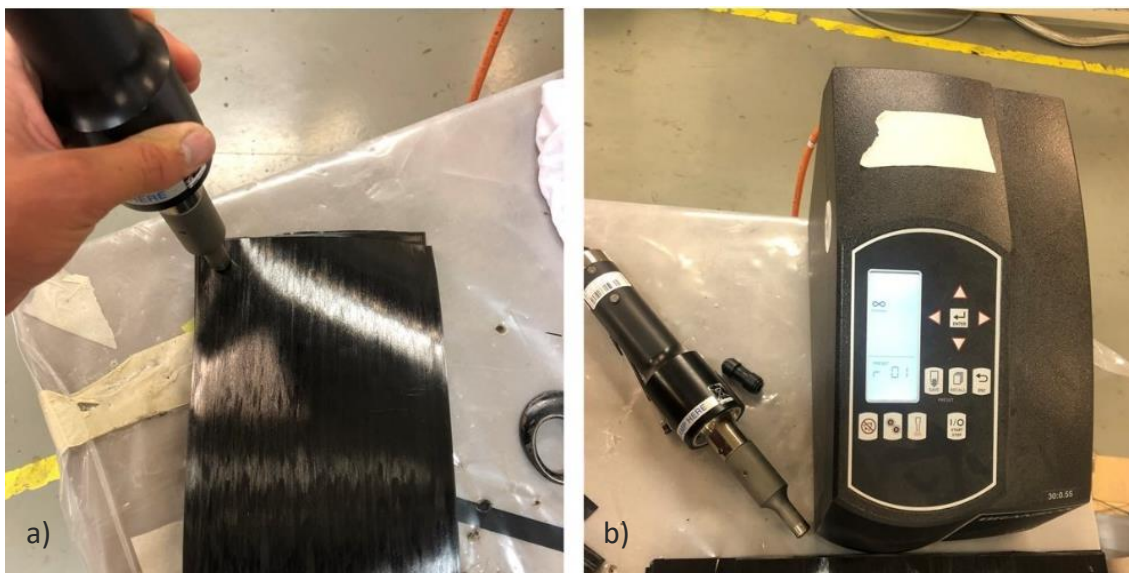
Figura 28 – a) Processo de soldadura manual das camadas de material e b) sonotrodo utilizado
