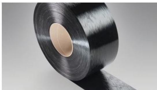
Figura 24 – Rolo de pré-impregnado unidirecional TenCate Cetex® TC910 [79]
