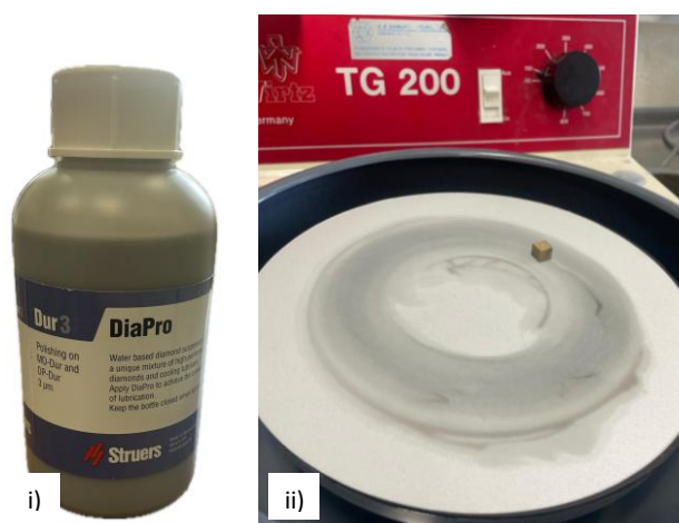
Figura 39 - Polimento dos provetes com suspensão de diamante para ensaios micrográficos: i) suspensão de diamante DiaPro Dur3 da Struers e ii) processo de polimento no equipamento Jean Wirtz TG 200.
