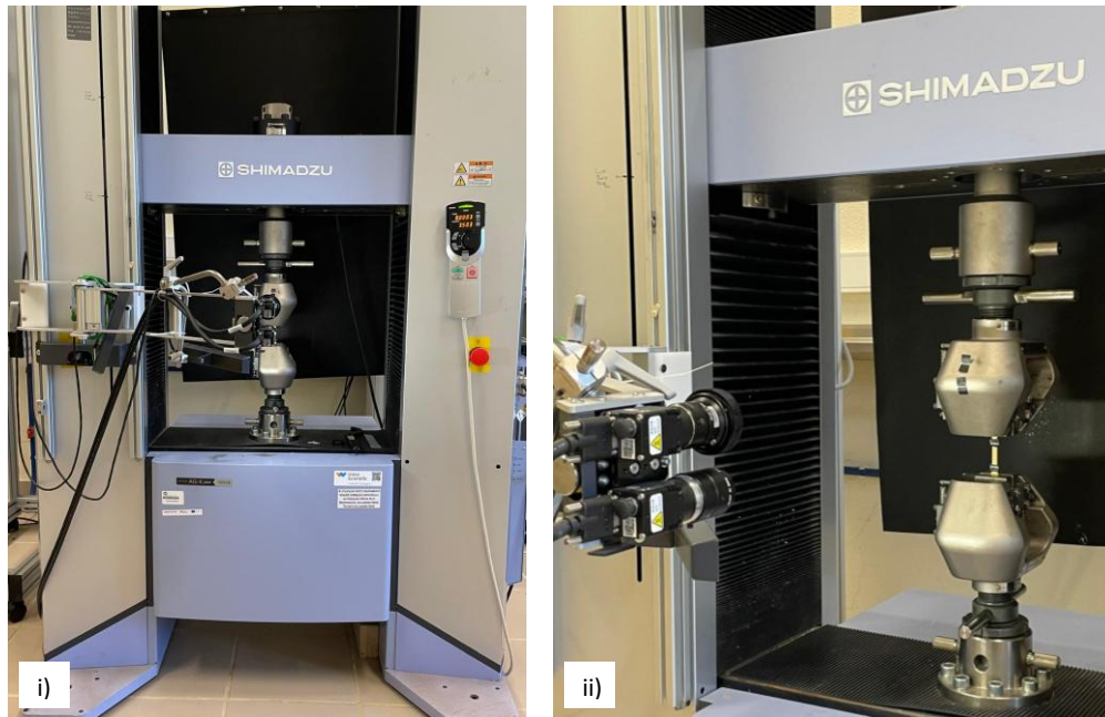
Figura 33 - Shimadzu Autograph AG-X plus 100kN: i) vista geral da máquina universal de ensaios e ii) detalhe do sistema de extensometria por vídeo TRViewX.
