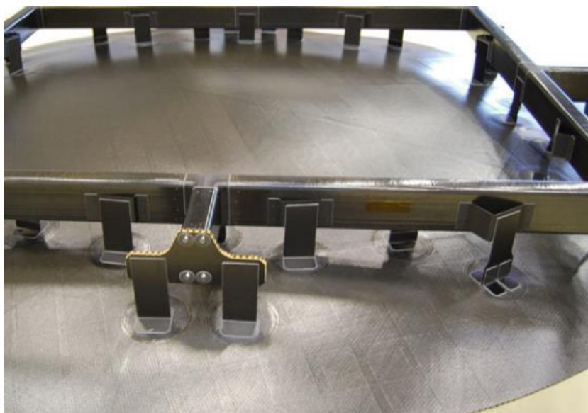
Figura 28 - Face refletora traseira unida a compósito monolítico [5]
