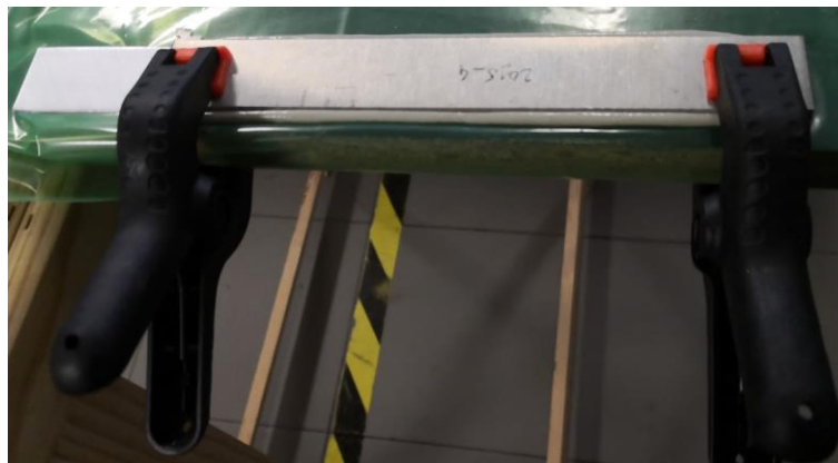
Figura 60 - Posicionamento dos grampos para alinhamento dos provetes
