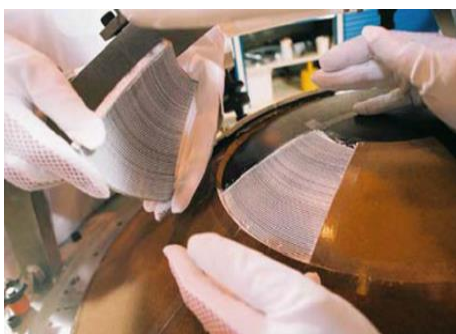
Figura 12 - Carapaça frontal da aeronave Beagle 2, durante montagem a), após montagem b) [5]
