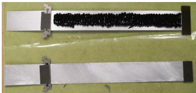
Figura 59 - Aplicação do adesivo nos aderentes flexíveis
