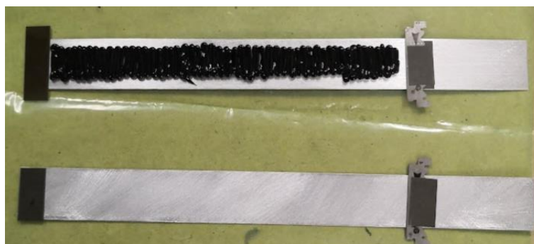
Figura 41 - Colocação de lâminas para garantir espessura mínima
