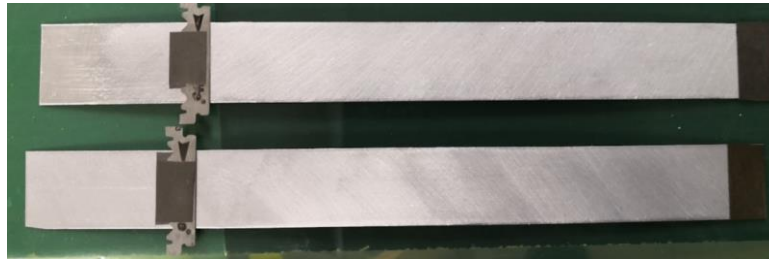
Figura 58 - Colocação das lâminas de aço inoxidável no aderente rígido
