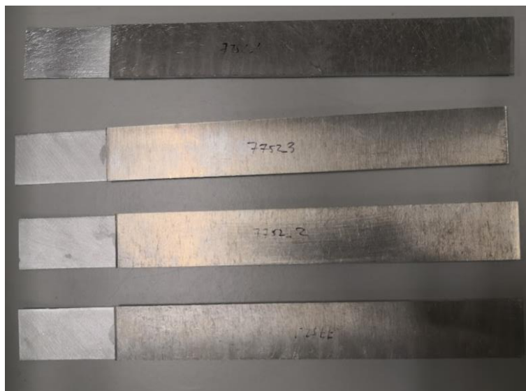
Figura 61 - Provete após remoção das lâminas e excesso de adesivo
