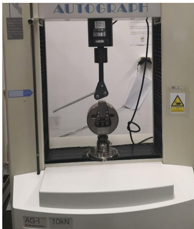
Figura 62 - Posicionamento de um provete de ensaio floating roller peel test numa máquina de ensaios Shimadzu® AG-1
