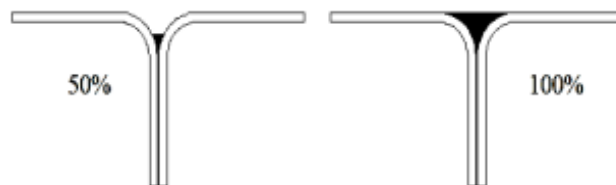
Figura 40 - Filete em juntas T com 50% enchimento a), 100% enchimento b) [52]
