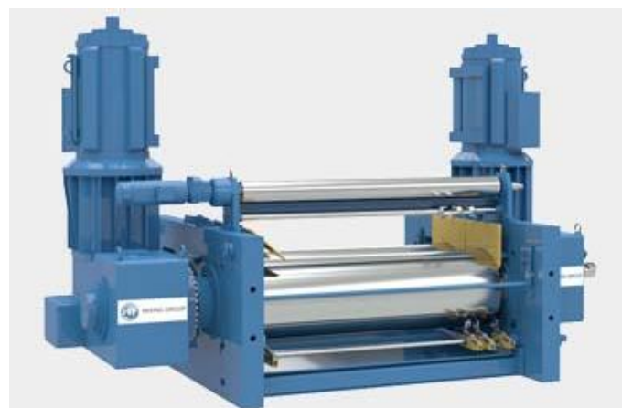
Figura 3.10 Configuração dos rolos do moinho de homogeneização na máquina de mistura [27]
