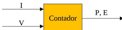
Figura 5.1 Entradas e saídas do contador de energia elétrica
