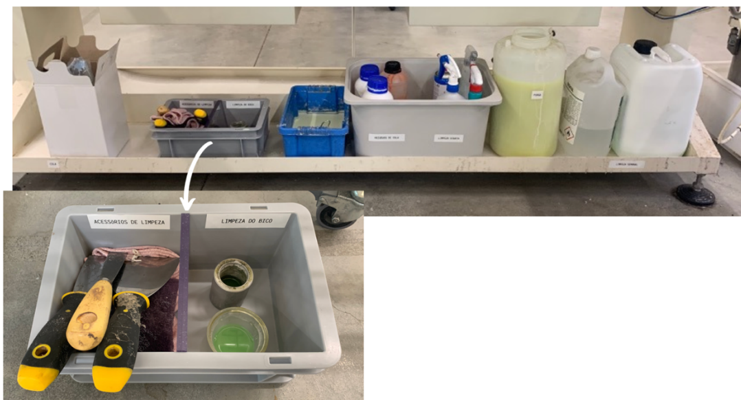
Figura 57 – Base do robô após a aplicação do 5S
