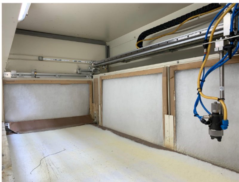
Figura 39 – Utilização dos novos Filtros Laterais
