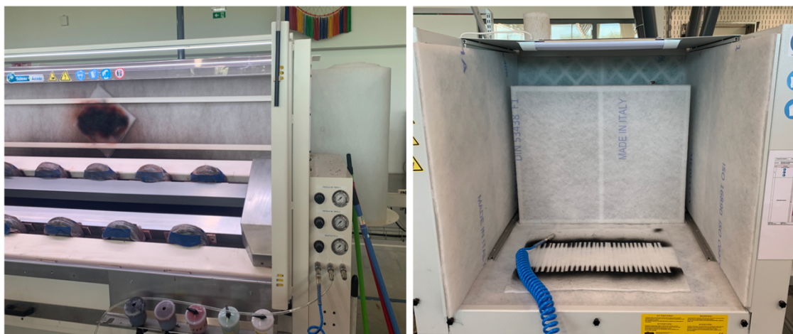
Figura 36 – Implementação dos Filtros adequados no banco de coloração A e na cabina Silpar
