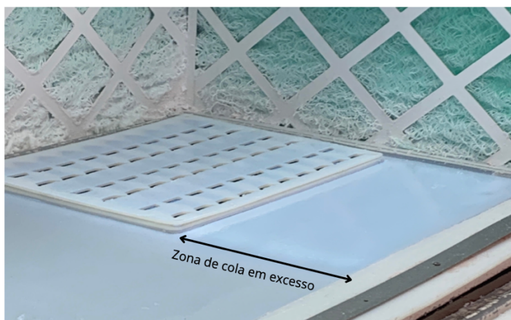
Figura 55 – Cola em excesso durante o processo de colagem, sem a programação do robô
