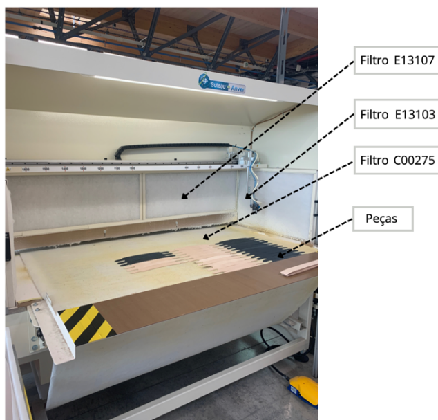
Figura 18 – Robô de cola em tapete da linha P3
