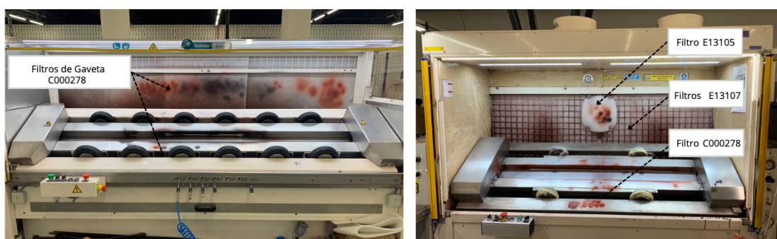
Figura 19 – Filtros utilizados nas duas tipologias de bancos de coloração
