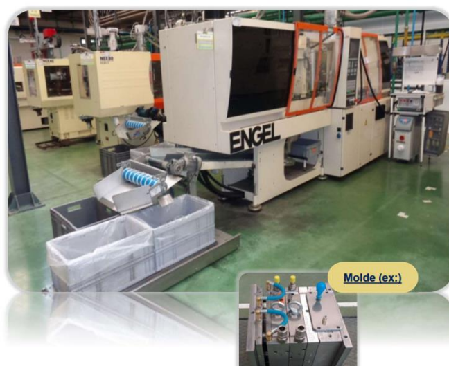
Figura 31- Molde de injeção
