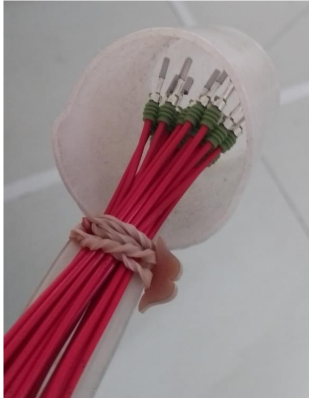
Figura 20- Acondicionamento de terminais
