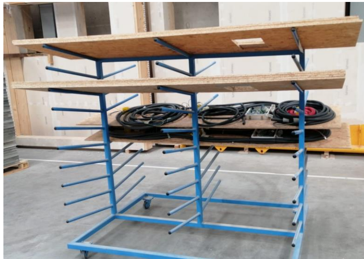
Figura 13 – Carrinho de suporte utilizado no armazenamento de paredes infraestruturadas finalizadas.
