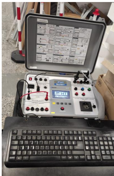
Figura 23 – Equipamento de testes multifuncional HT FullTest 3 .
