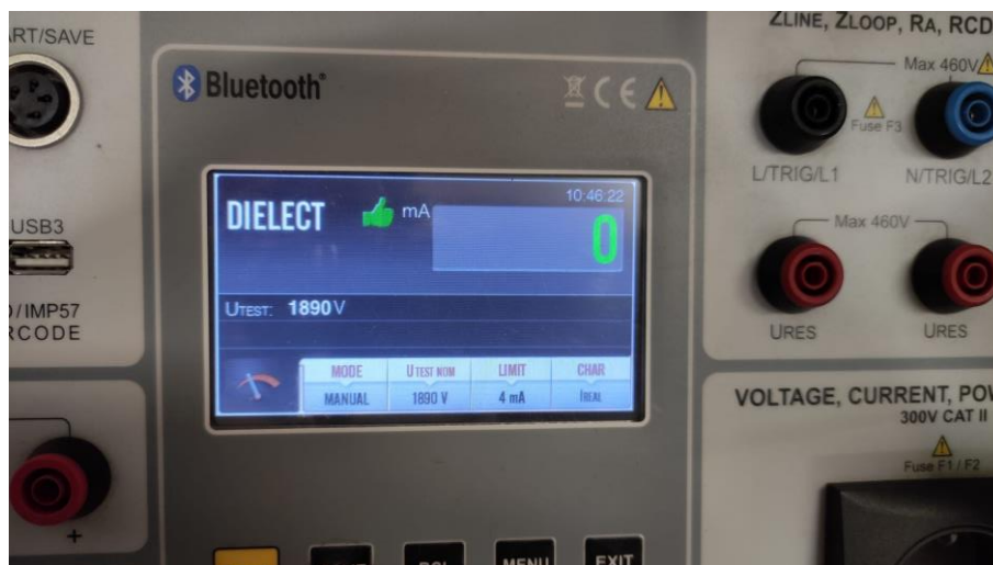
Figura 30 - Equipamento de testes após realização de ensaio de rigidez dielétrica.
