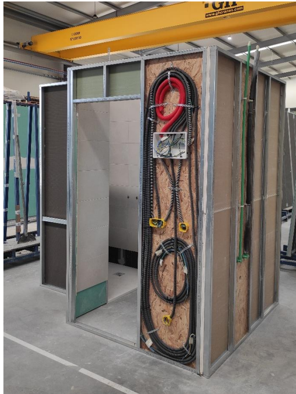
Figura 22 – Módulo off-site WC de um quarto de hotel.
