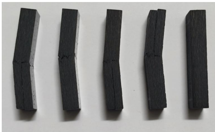
Figura 45 - Ensaio de flexão em 3 pontos: estado pós-ensaio dos provetes sem descontinuidade
