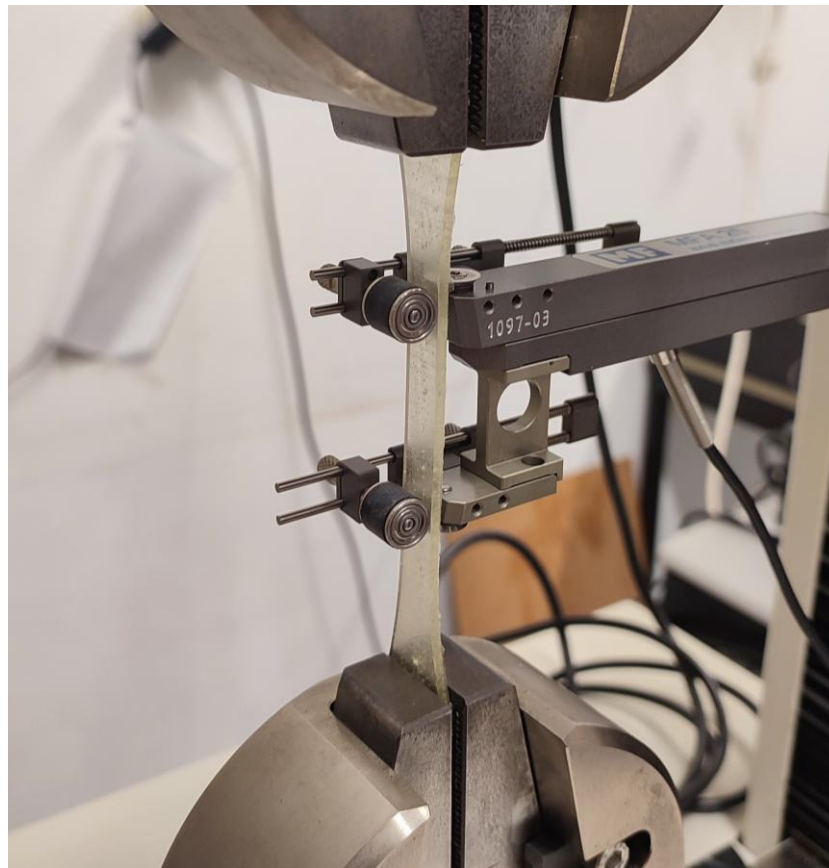
Figura 51 - Set-up do ensaio à tração dos provetes bulk
