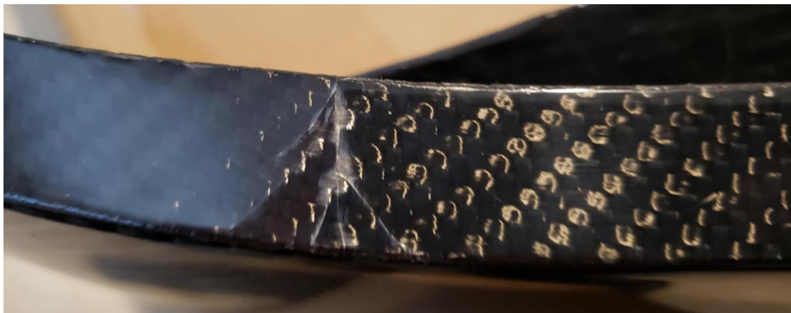
Figura 18 - Fissura em componente de material composto CFRP
