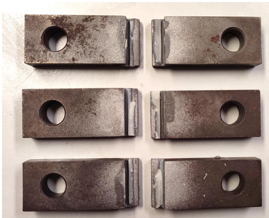
Figura 56 - Provetes TAST após a realização dos ensaios
