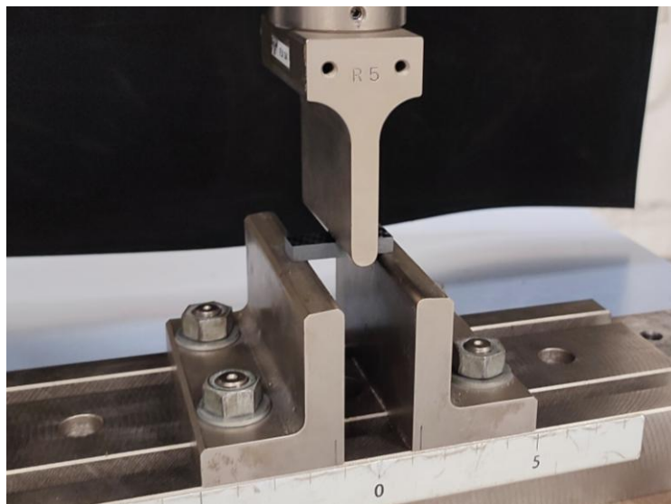
Figura 44 - Set-up do ensaio de flexão em 3 pontos do material composto
