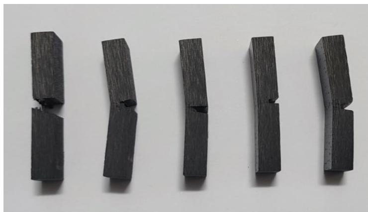
Figura 46 - Ensaio de flexão em 3 pontos: estado pós-ensaio dos provetes com descontinuidade
