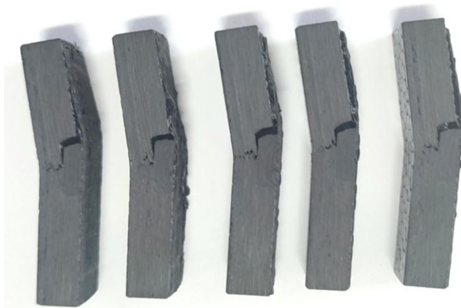
Figura 74 - Provetes reparados por preenchimento da fissura após ensaios de flexão em 3 pontos
