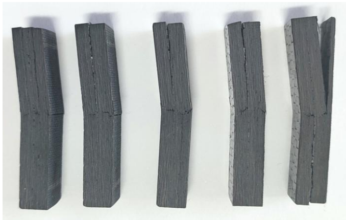
Figura 75 - Provetes reparados por substituição das peles danificadas, em formato de escalonado, após ensaios de flexão em 3 pontos
