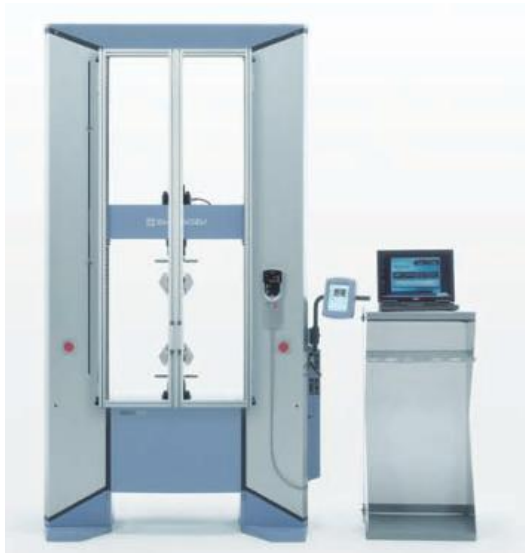
Figura 71 - Equipamento utilizado nos ensaios de flexão em 3 pontos (Shimadzu 2024)
