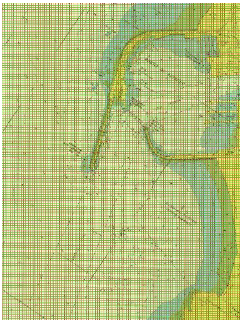
Figura 44 - Malha utilizada para realizar o levantamento topo-hidrográfico da zona de estudo.
