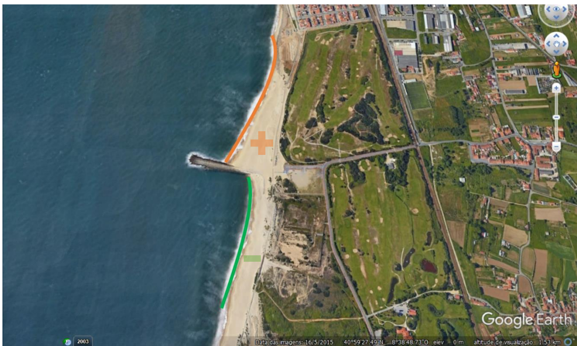
Figura 2. Efeitos da construção do esporão em Espinho. (Adaptado de Google Earth)
