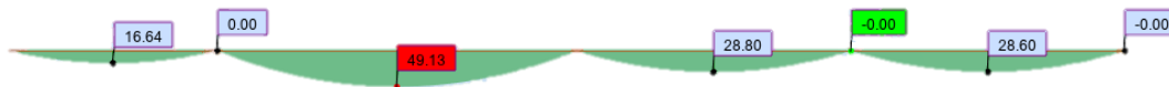
Figura 6-10- Diagrama de momentos fletores da viga V2.C em estado limite de utilização.
