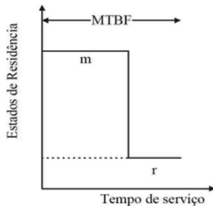
Figura 7 - Representação gráfica do Mean Time Between Failures (dois estados) [3]
