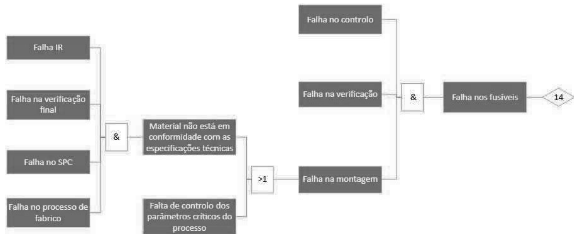
Figura 45 - Diagrama FTA para a falha nos fusíveis
