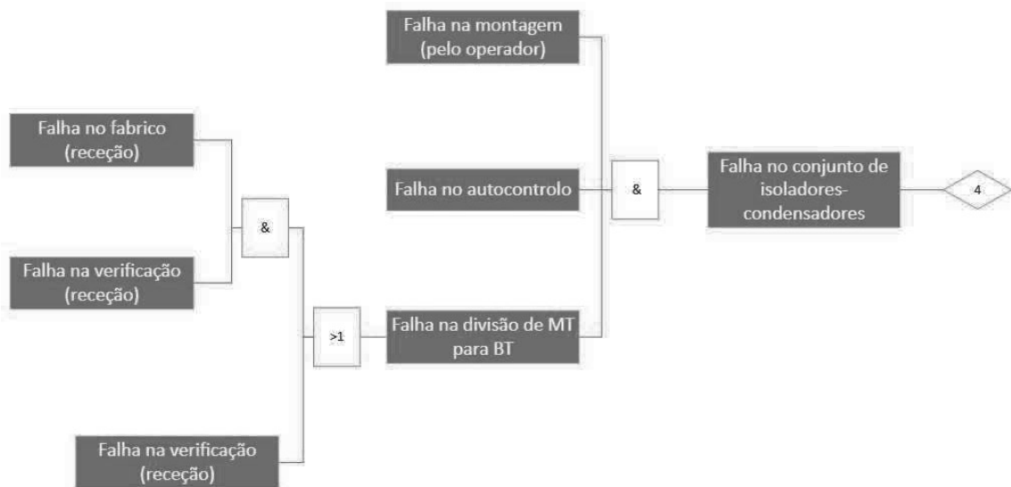
Figura 35 - Diagrama FTA para a falha nos indicadores divisores capacitivos
