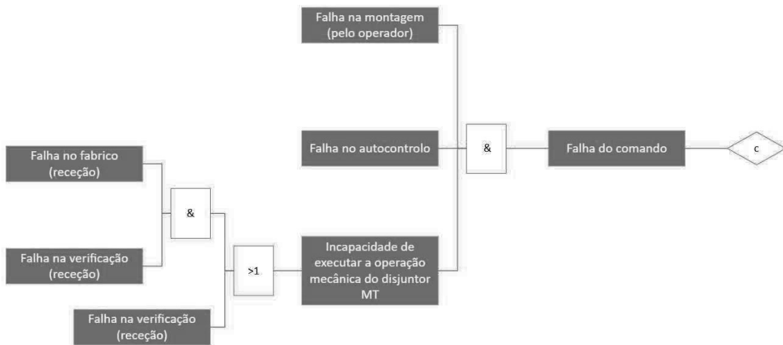
Figura 33 - Diagrama FTA para a falha no comando
