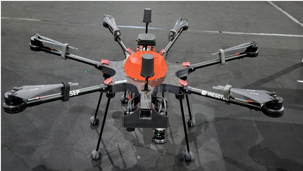
Figura 4.2: STORK II: UAV usado para recolha do dataset
