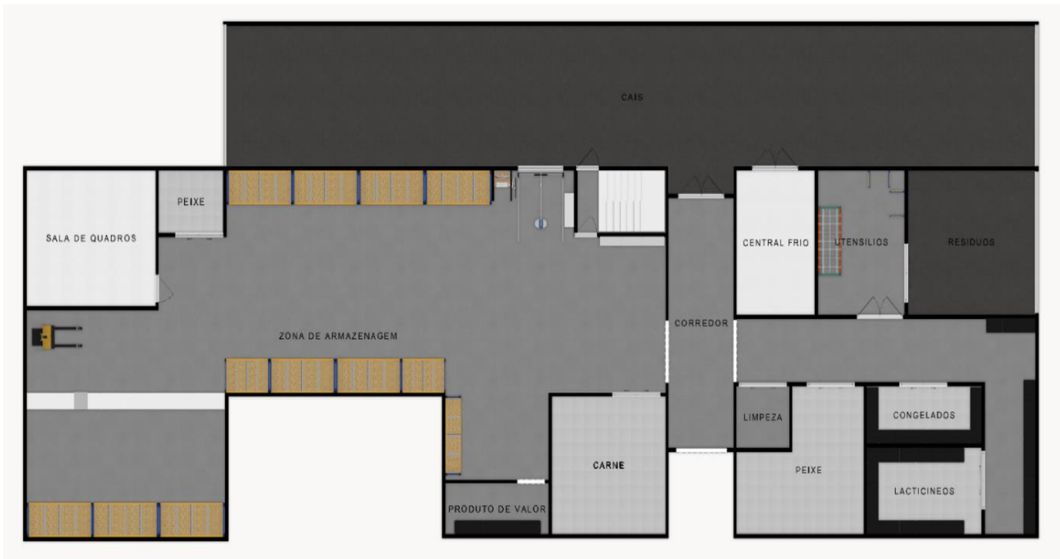
Figura 8 - Planta do Armazém
