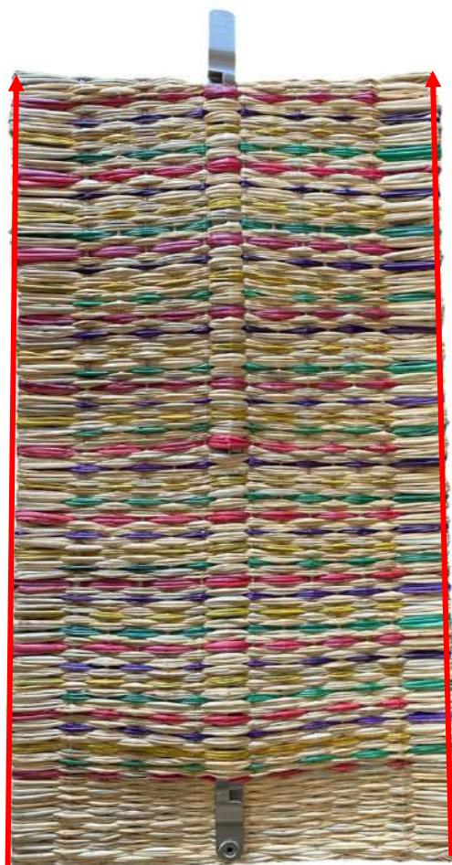
Figura 263 Tira referente á bolsa casual 1, com problema de afunilamento por movimentação da trama durante o processo de produção.
