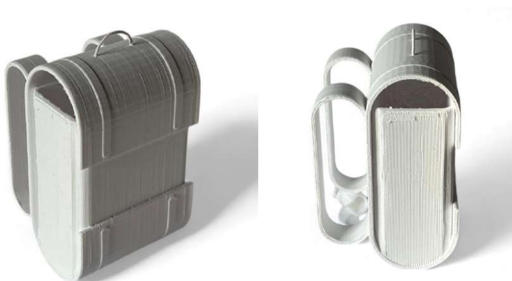
Figura 148 e Figura 149 Maquetização da mochila à escala 1:5, através do processo de impressão 3D.
