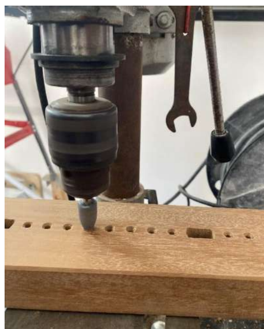
Figura 230 Escareamento e acabamento dos furos.
