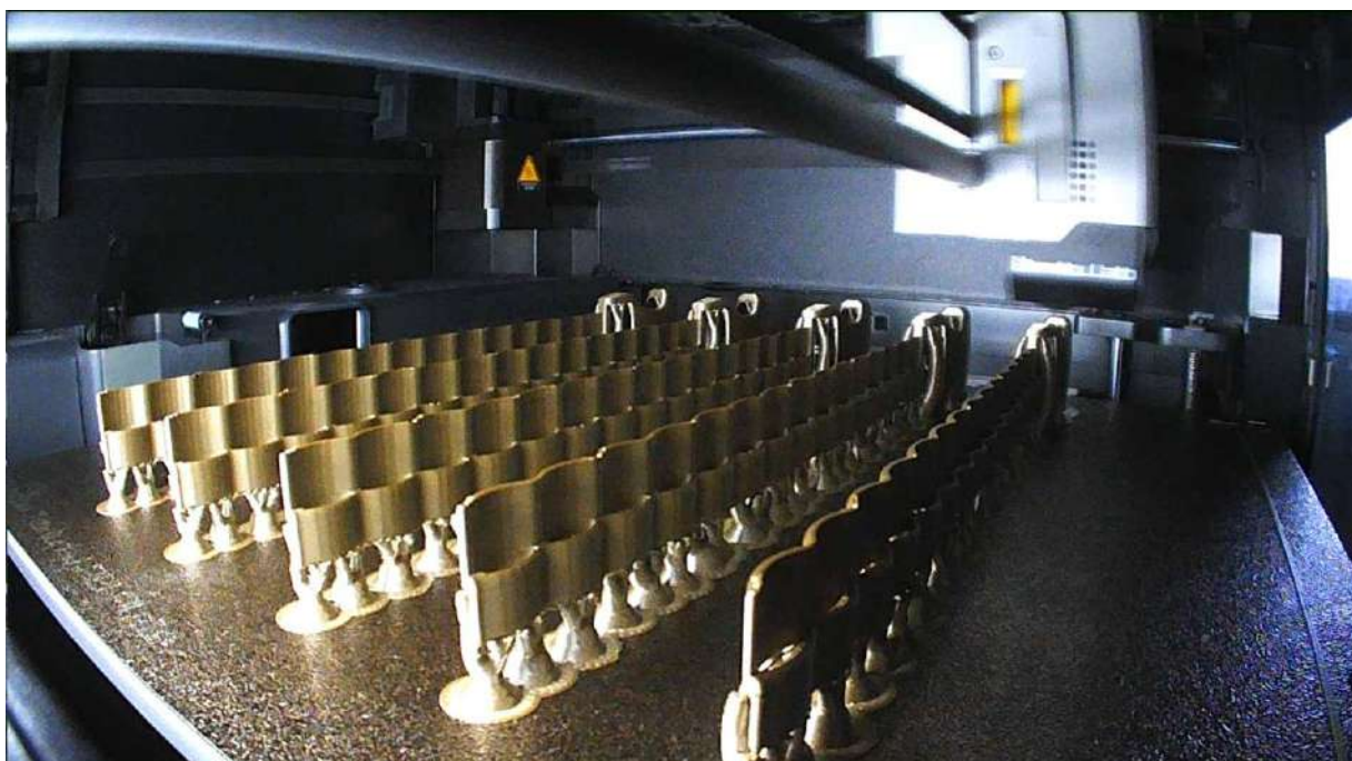
Figura 244 Processo de impressão da trama de fecho de encaixe fêmea.
