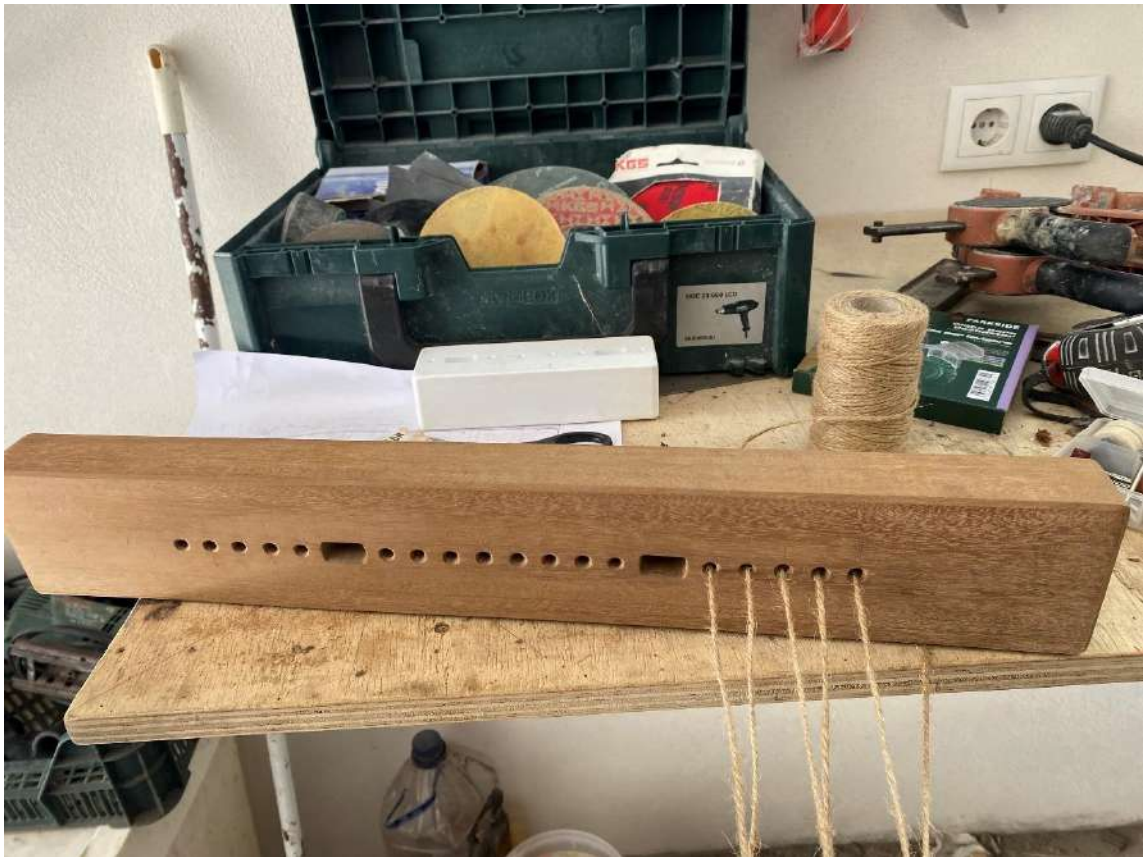
Figura 231 Teste de passagem do fio de juta e das tramas pelo pente.
