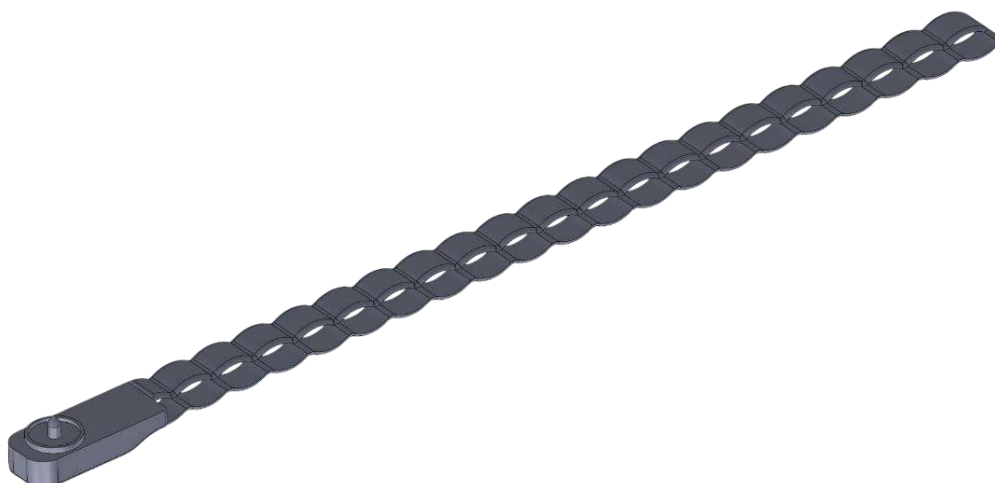
Figura 112 Desenvolvimento de trama com fecho macho de botão.
