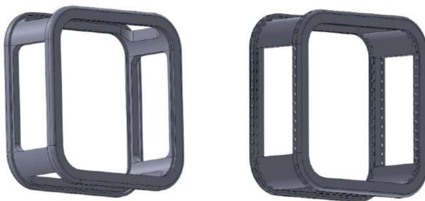
Figura 79 e Figura 80 Modelação em Solidworks da estrutura interna da bolsa da figura 76
