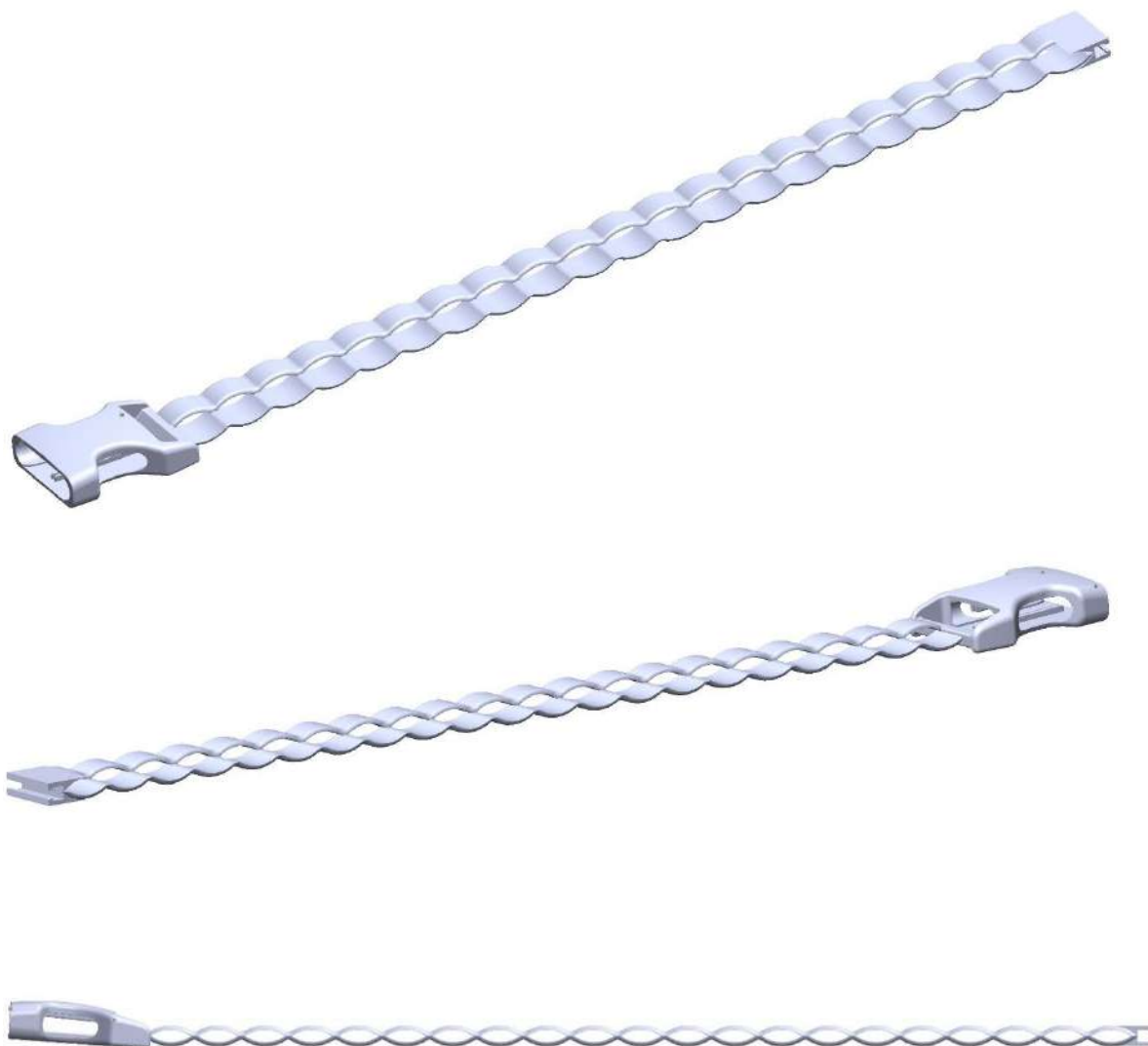
Figura 172 Modelação de trama constituída por fecho fêmea de encaixe e adaptador extensor no corpo da trama.
