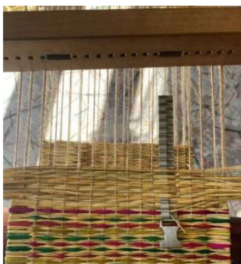
Figura 259 Junco tecido ao longo do corpo da trama.
