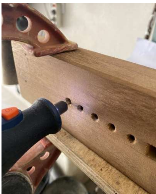
Figura 229 Remoção de lascas dos furos.
