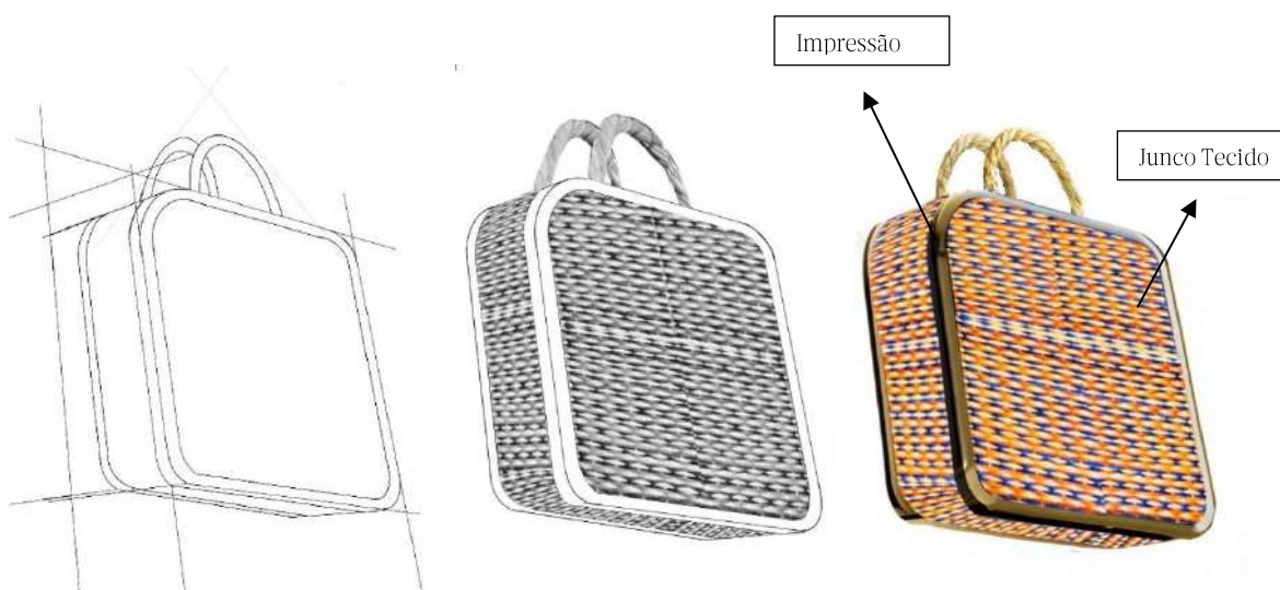
Figura 76, Figura 77 e Figura 78 Exploração visual de bolsa com peça impressa em 3D, como elemento estrutural da mesma, e união do junco tecido à estrutura como elemento decorativo.
