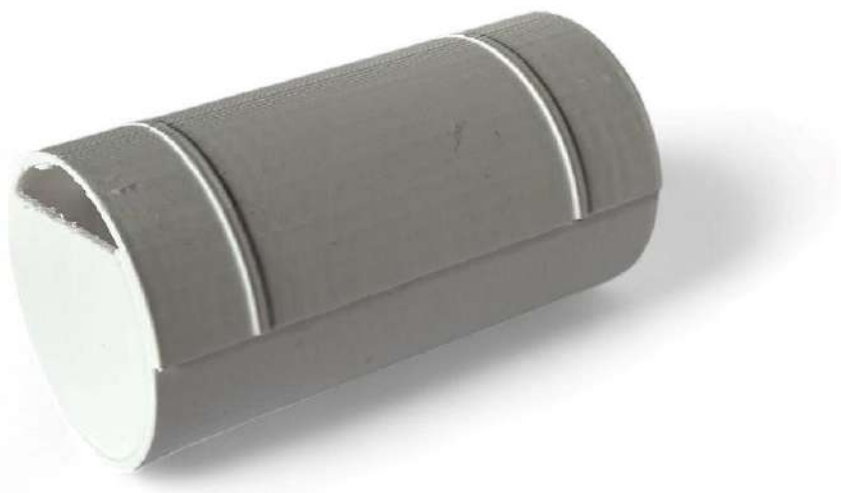
Figura 170 Maquetização da bolsa desenvolvida à escala 1:5, através do processo de impressão 3D.
