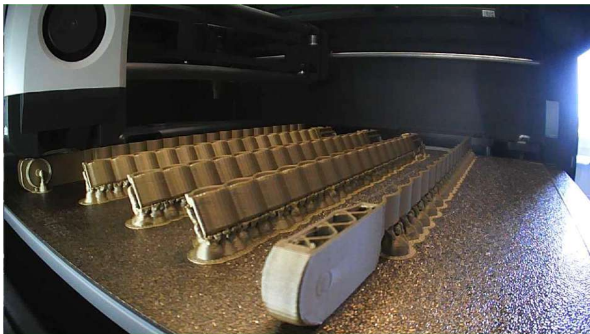
Figura 242 Processo de impressão da trama de fecho de encaixe macho.
