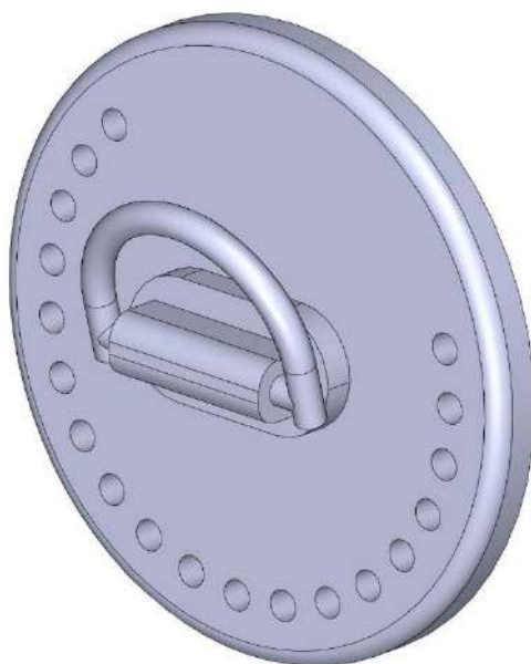
Figura 270 Lateral da bolsa com anel de alça de dimensões mais reduzidas, modelação em Solidworks, diâmetro 10, correspondente a bolsa casual 2.
