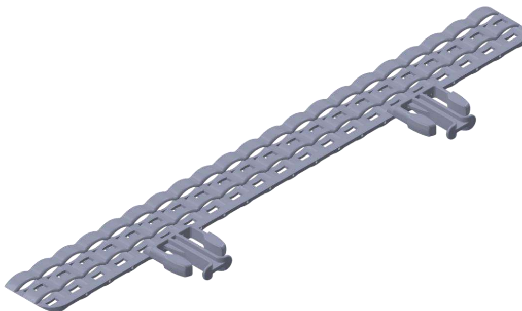
Figura 110 Segundo formato de corpo da trama com fechos machos embutidos.
