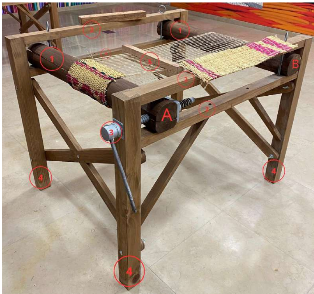
Figura 16 Vista 1 do tear manual: (1) – Rolo Móvel A e Rolo Fixo B; (2) – Barandas; (3) – Fuso; (4) – Pés; (5) – Pendentes/Pente, Imagem captada pelo autor
