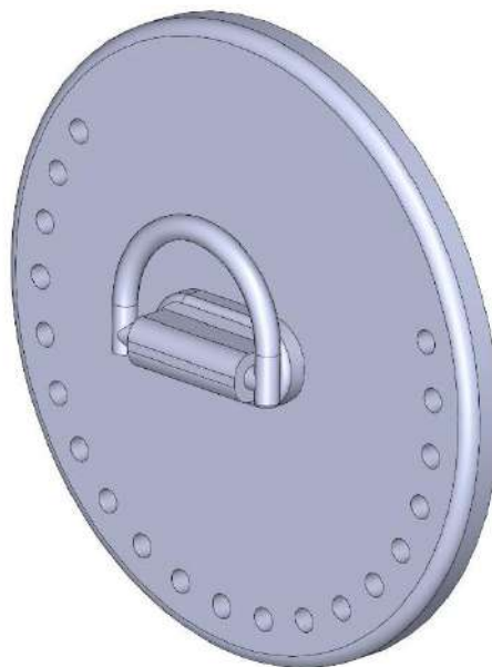
Figura 267 Lateral da bolsa com anel de alça de maior dimensões, modelação em Solidworks, diâmetro 13, correspondente a bolsa casual 1.
