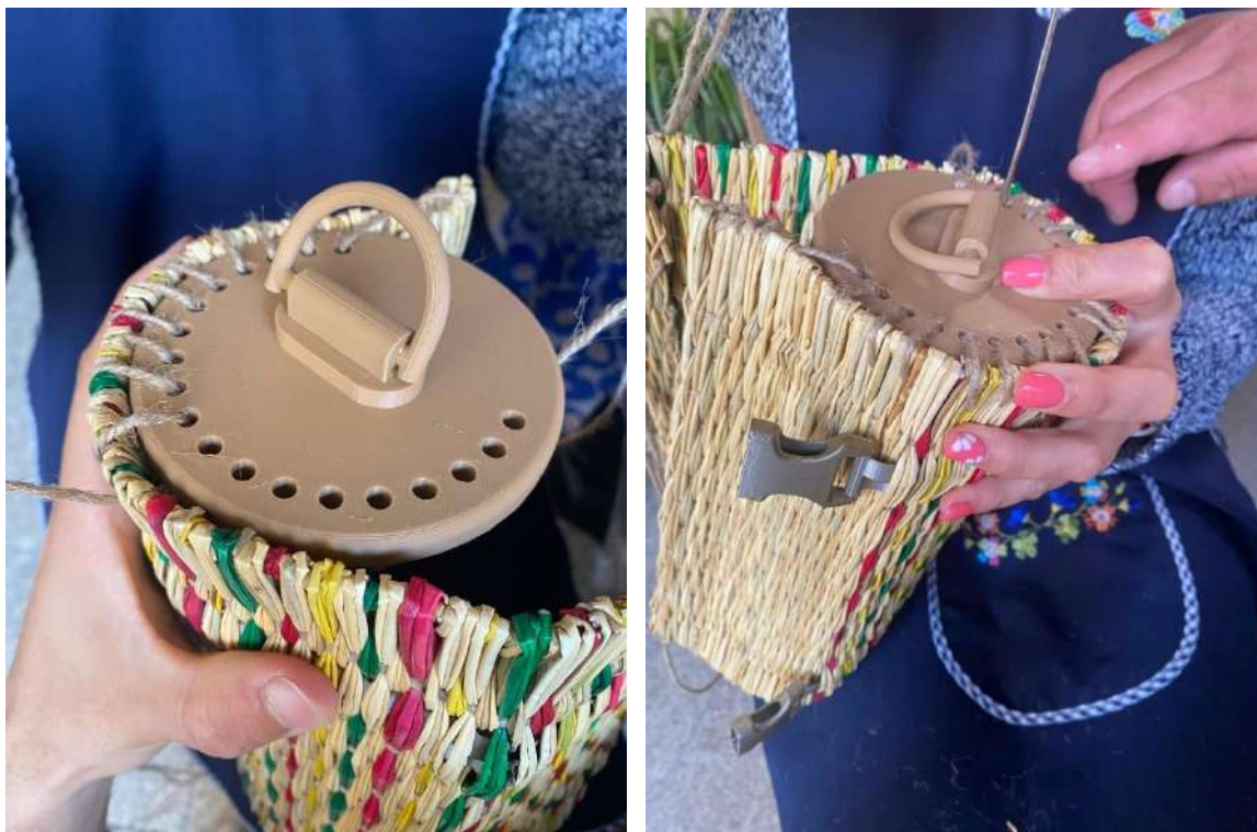
Figura 283 e Figura 284 Construção do protótipo final da bolsa 2, união da tira de junco e das tampas através do método de costura em ponto cruzado.
