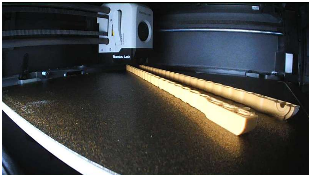
Figura 133 Processo de Impressão 3D das tramas com as alterações realizadas, Material PLA.
