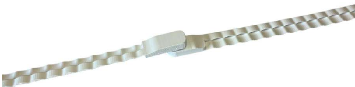
Figura 125 Ensaio de encaixe entre o fecho macho e o fecho fêmea das tramas.
