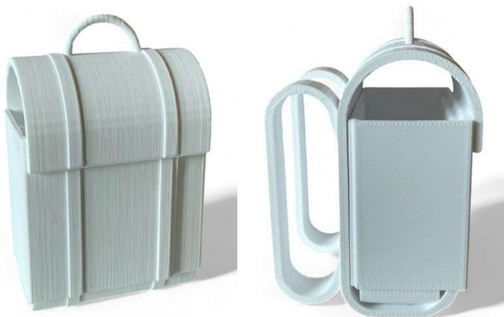
Figura 141 Maquetização da mochila à escala 1:5, através do processo de impressão 3D.
