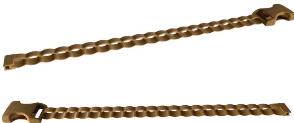
Figura 182 e Figura 183 Trama fêmea impressa em 3D, através da utilização de filamento PLA.
