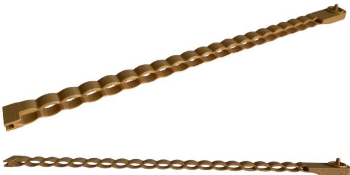
Figura 185 e Figura 186 Trama macho impressa em 3D, através da utilização de filamento PLA.
