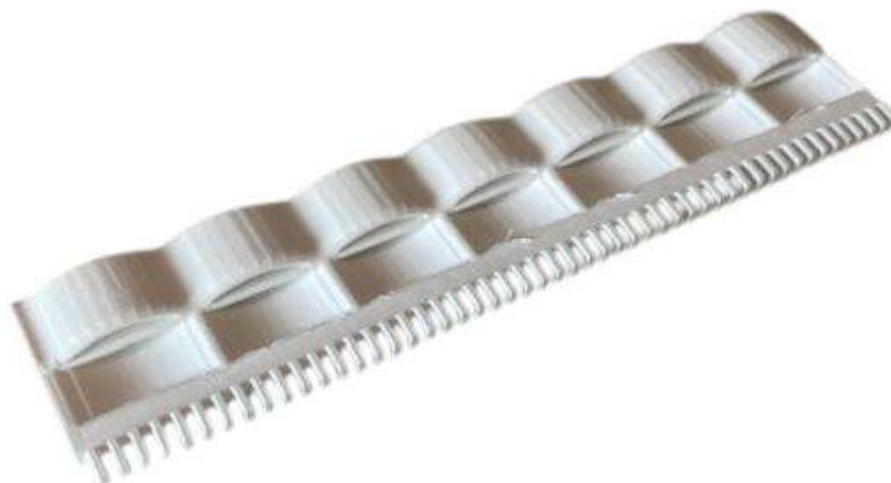
Figura 126 Impressão 3D das tramas com fecho de corrente dentada.
