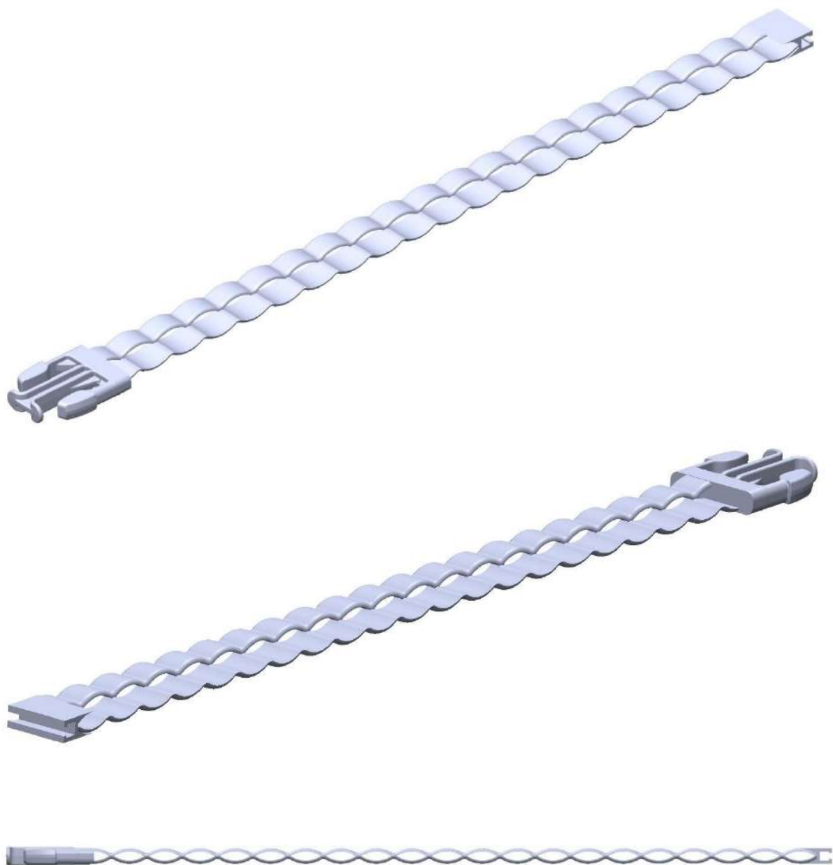
Figura 173 Modelação de trama constituída por fecho macho de encaixe e adaptador extensor no corpo da trama.
