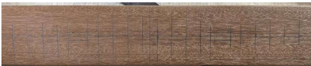
Figura 228 Marcação dos furos no pente.
