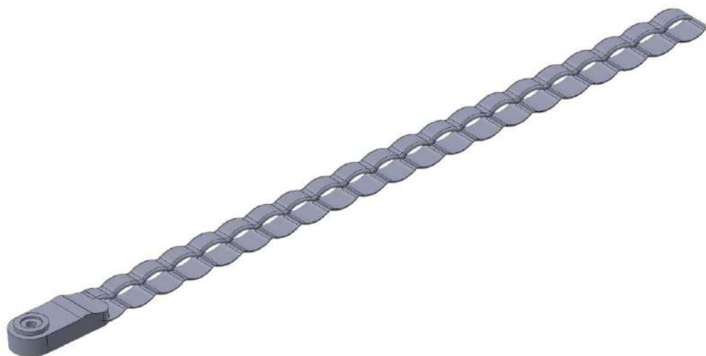
Figura 113 Desenvolvimento de trama com fecho fêmea para encaixe de botão por pressão.
