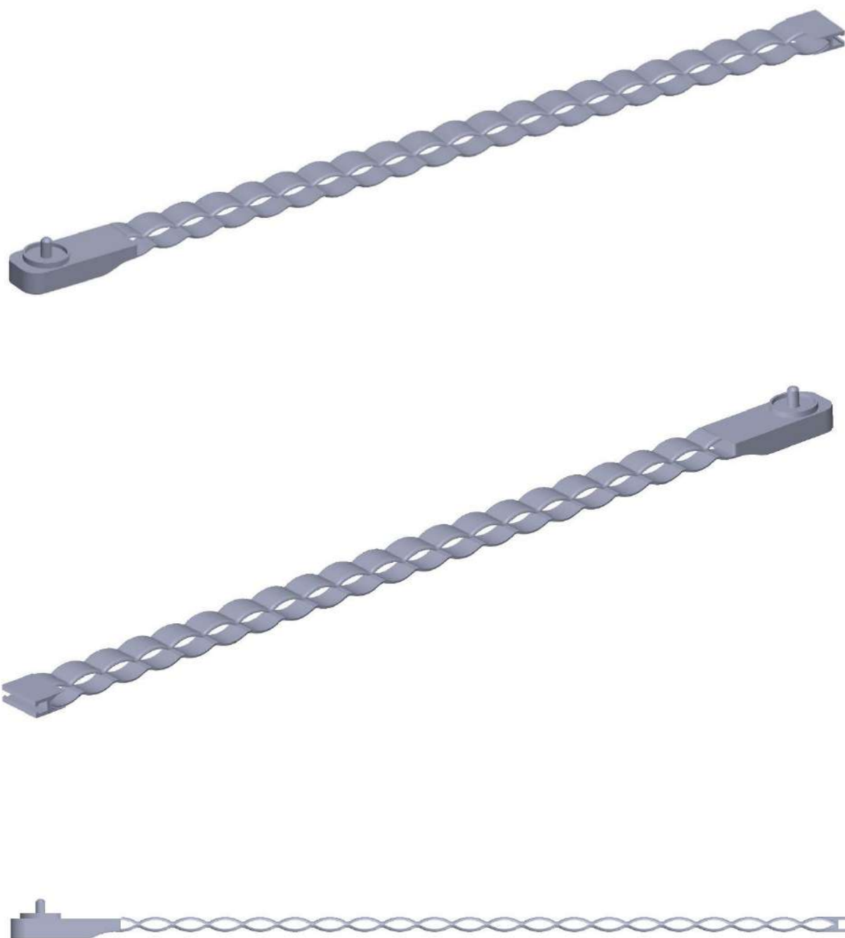
Figura 175 Modelação de trama constituída por fecho macho de botão por pressão e adaptador extensor no corpo da trama.
