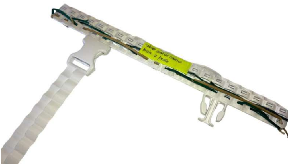
Figura 122 Ensaio de encaixe entre o segundo formato de trama com fecho macho e trama com fecho fêmea.
