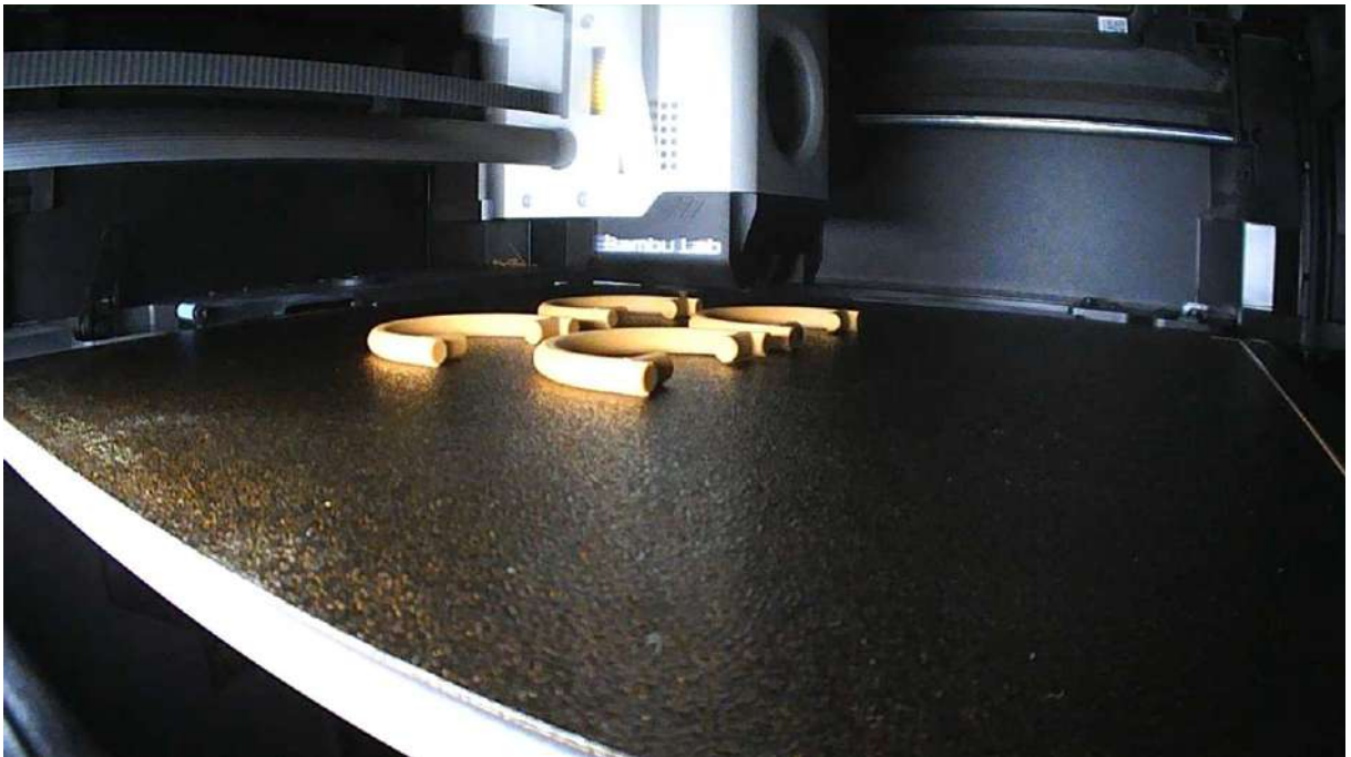
Figura 273 Impressão 3D dos anéis das alças para aplicar nas laterais das bolsas, utilização de material PLA.
