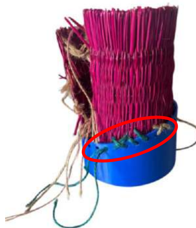
Figura 55 Utilização do método tradicional para unir a peça impressa ao junco tecido
