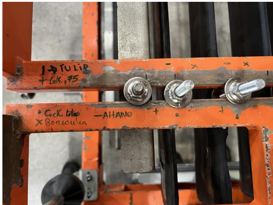
Figura 35 - Despaletizador: Marcação e legenda pré-definidas
