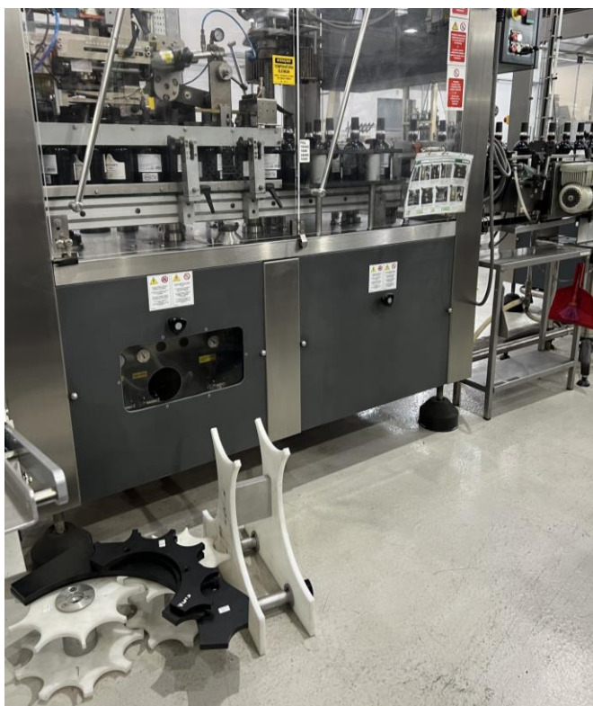
Figura 27 - Peças a substituir junto da máquina
