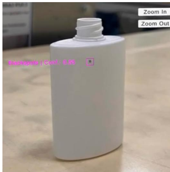
Figura 4.12: Interface com sobreposição de defeitos: caixas coloridas por tipo e etiquetas com nome e confiança
