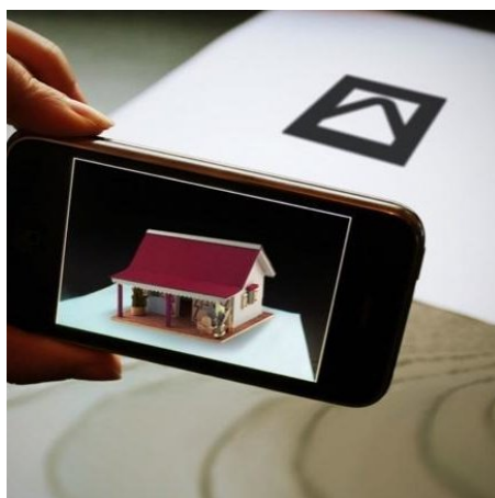
Figura 2.3: Exemplo de marker-based tracking (Adaptada de [13])
