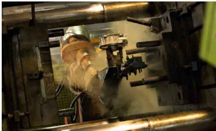
Figura 4.8: IRB 4400 da ABB na fábrica de fundição da MP Filtri [54].
