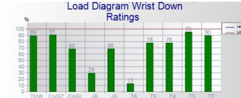
Figura 5.13: Resultados do teste de cargas do R2 da célula B.
