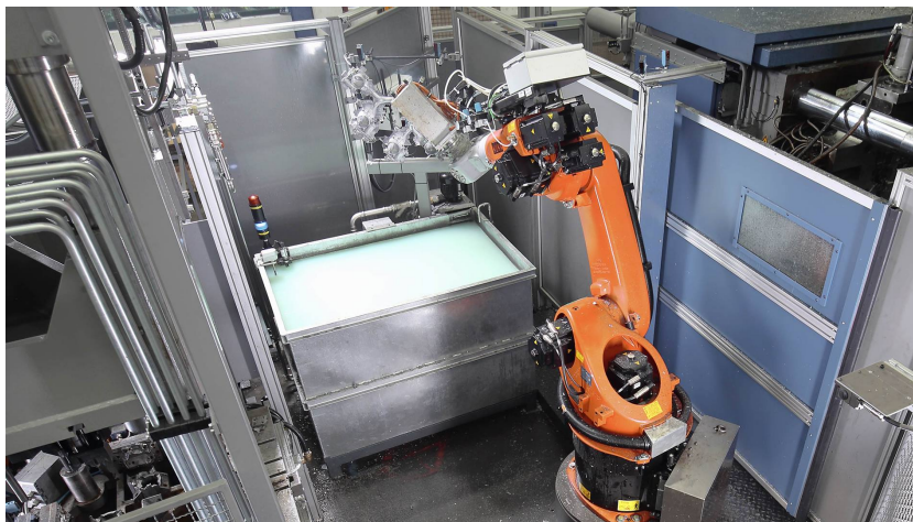
Figura 4.10: Submersão da peça para arrefecimento [56].
