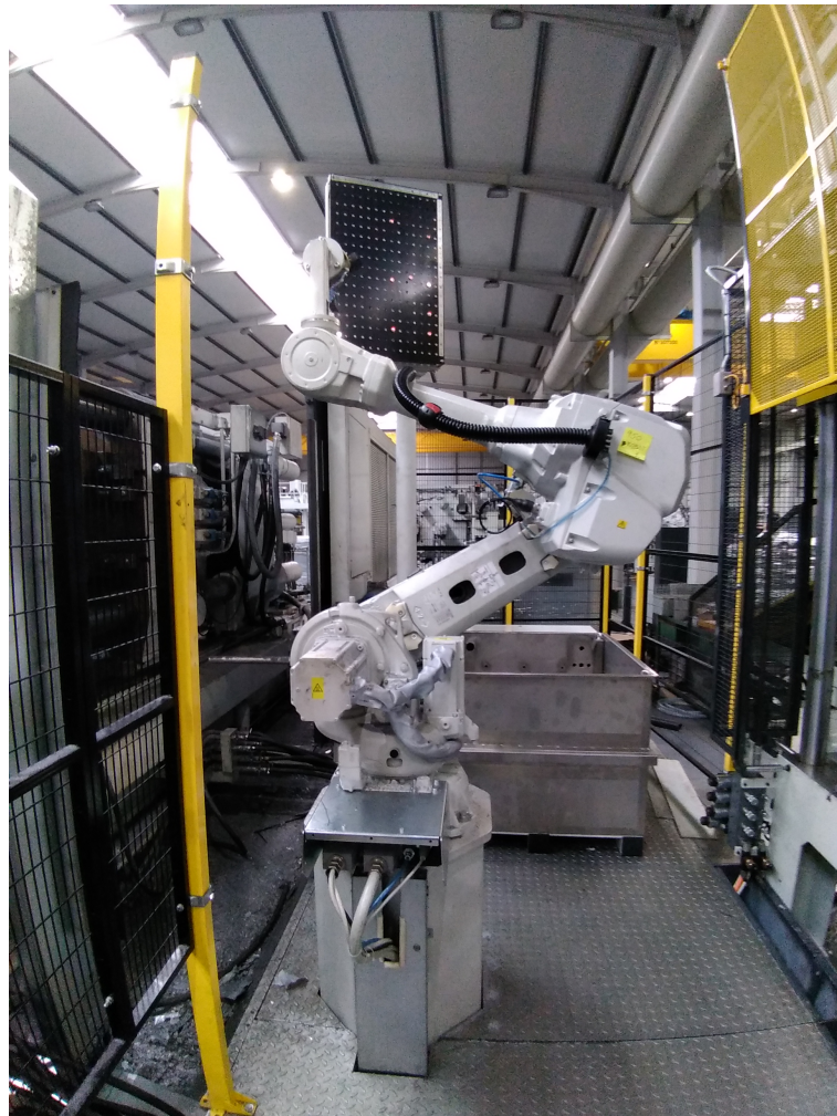
Figura 7.5: Robô extrator da célula B em posição de home .
