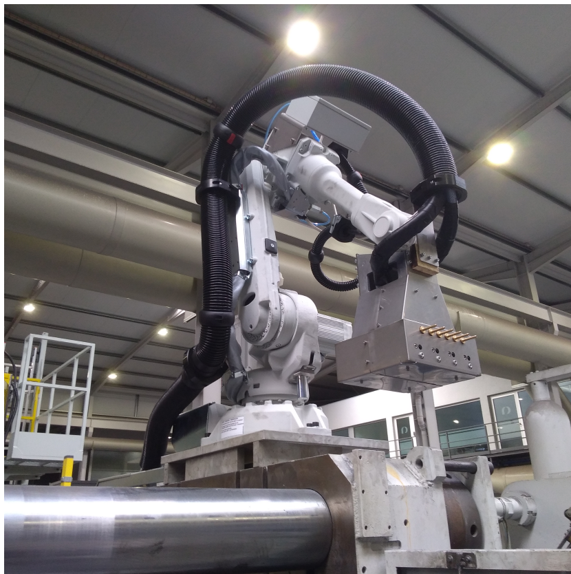
Figura 7.6: Robô lubrificador da célula B em posição de home .
