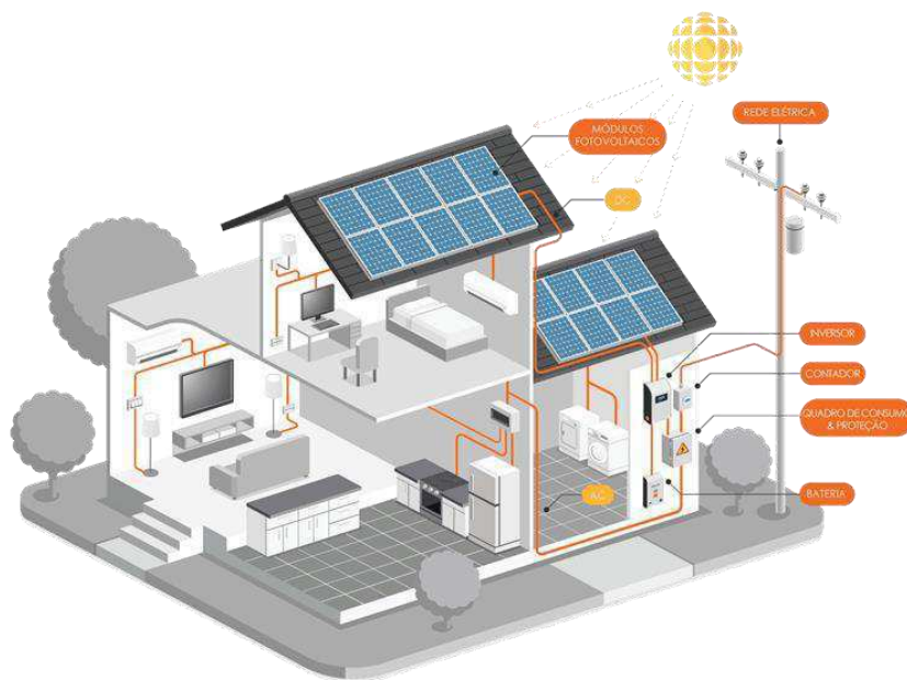
Figura 4 - Sistema de Autoconsumo Fotovoltaico [11].
