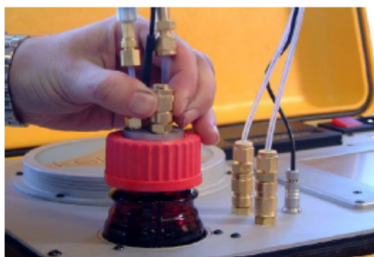
Figura 6 - Pressionar do adaptador rápido "fêmea"
