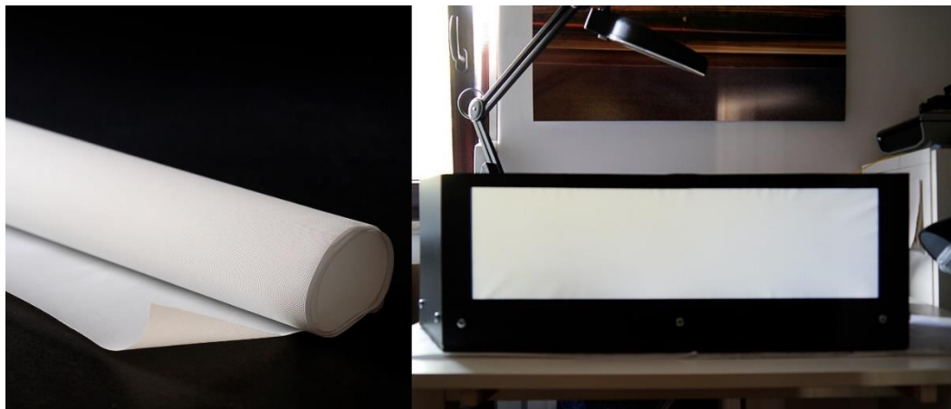
Figura 32 - Pormenor de retalho da cortina de duche e imagem da aplicação na caixa negra
