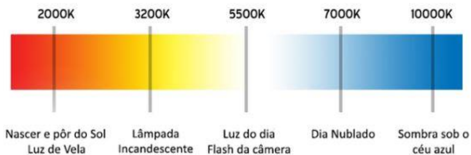
Figura 33 - Escala da temperatura de cor da luz em graus Kelvin Fonte: ( https://institutoprincipia.org )
