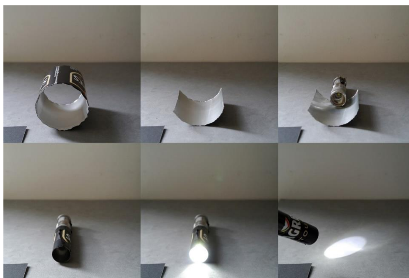
Figura 45 - Construção do cone modulador de luz reutilizando a chapa de uma lata
