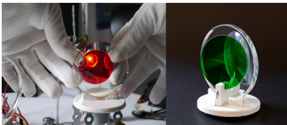
Figura 44 - Aspeto de pormenor da montagem dos elementos óticos e imagem do suporte circular que ligará ao mecanismo de rotação dedicado
