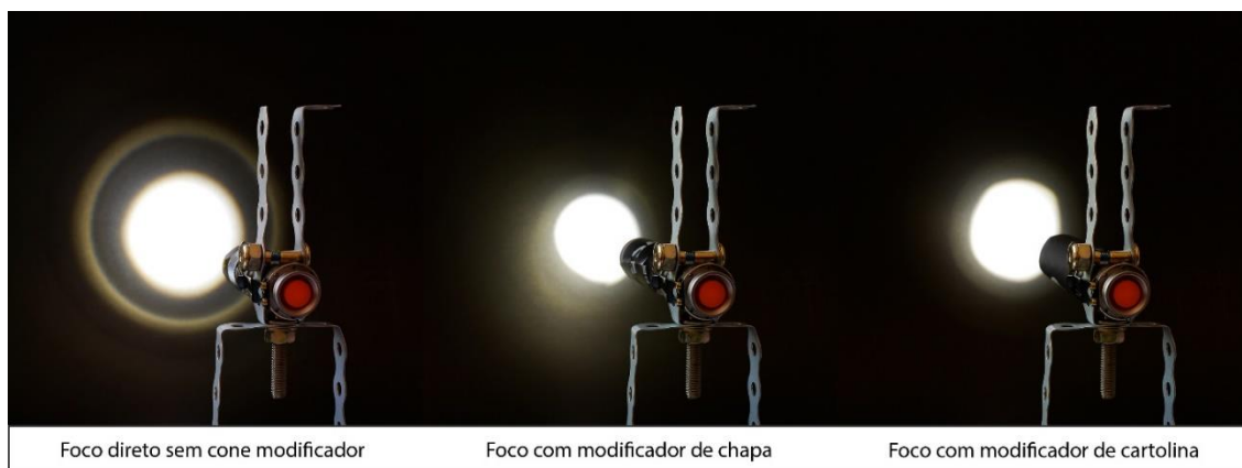
Figura 37 - Estudo sobre a concentração do foco para modelação de luz
