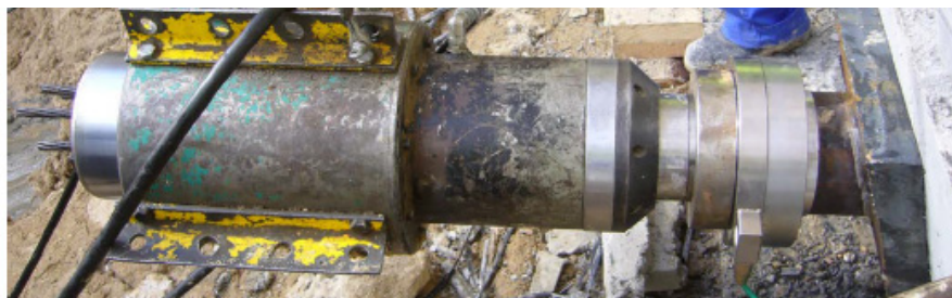
Figura 27. Equipamento para tensionar os cabos de ancoragens ( arquivo fotos RRC; com autorização ).
