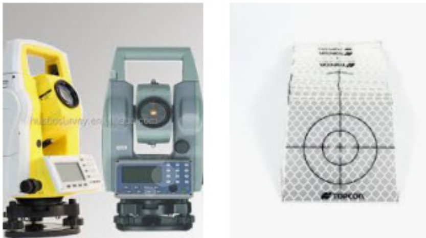
Figura 28. Aparelhos de leitura do tipo estação total e alvos topográficos. (adaptado Carlson CR+)
