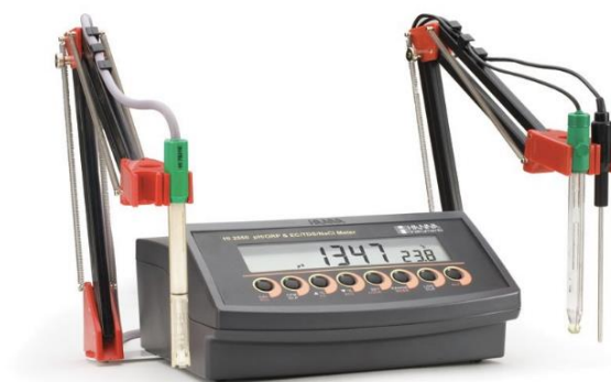
Figura 3.7 - Condutivímetro HI-2550, mede em simultâneo o pH, a condutividade elétrica e a temperatura (77)
