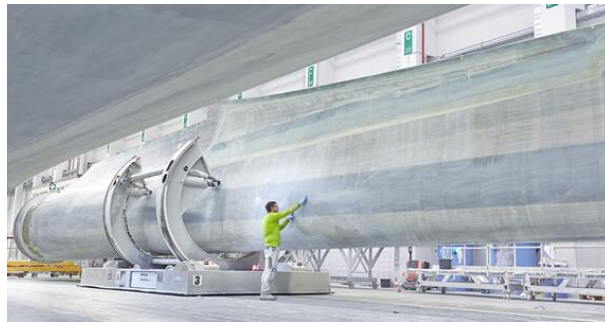
Figura 8 - Processo de produção de uma pá de turbina eólica
