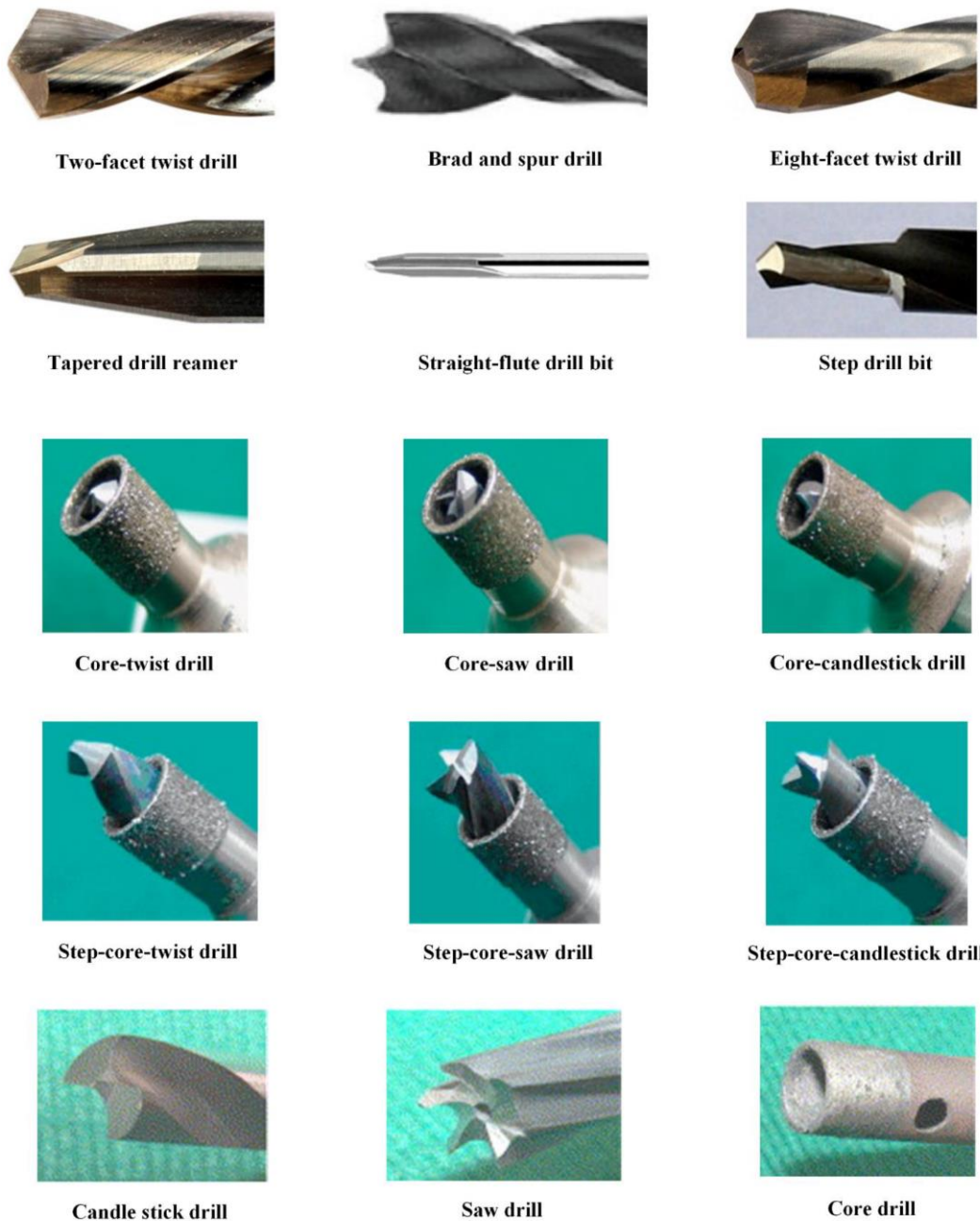
Figura 16 - Várias geometrias de brocas utilizadas na furação de compósitos poliméricos reforçado por fibras [21]
