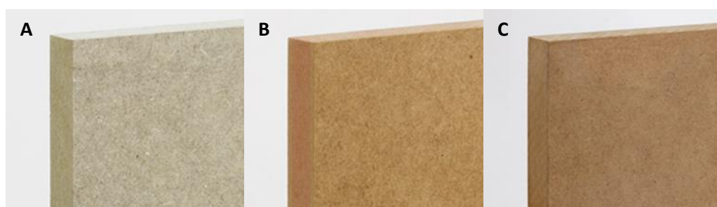
Figura 7 - Diferentes tipos de MDF: A - Hidrófugo, B - Ignífugo, C - Alta Densidade [12]
