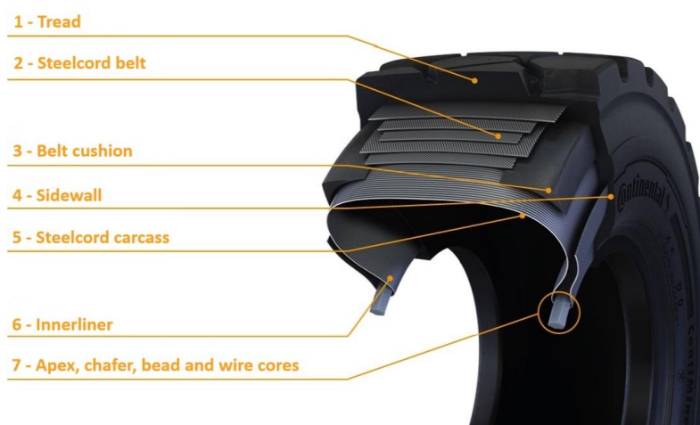
Figura 6 - Constituintes de um pneu Continental OTR; adaptado de [10]
