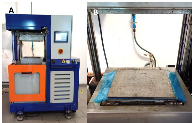
Figura 25 – A - prensa hidráulica de pratos quentes; B - disposição das placas na prensa
