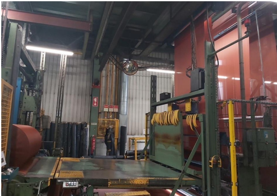
Figura 2.15 Zona de enrolamento da tela impregnada na máquina Zell.
