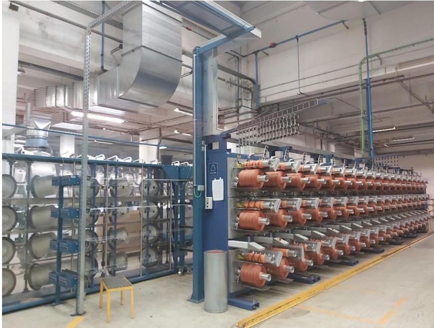
Figura 2.10 Zona de desenrolamento e enrolamento da corda da Single End 2.
