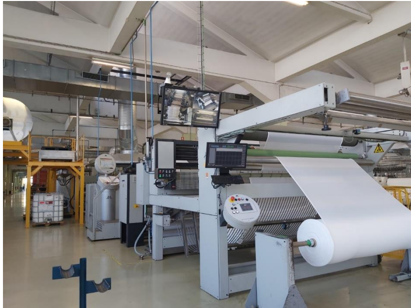
Figura 2.18 Zona de desenrolamento da secção de ramulagem para produção de malhas.
