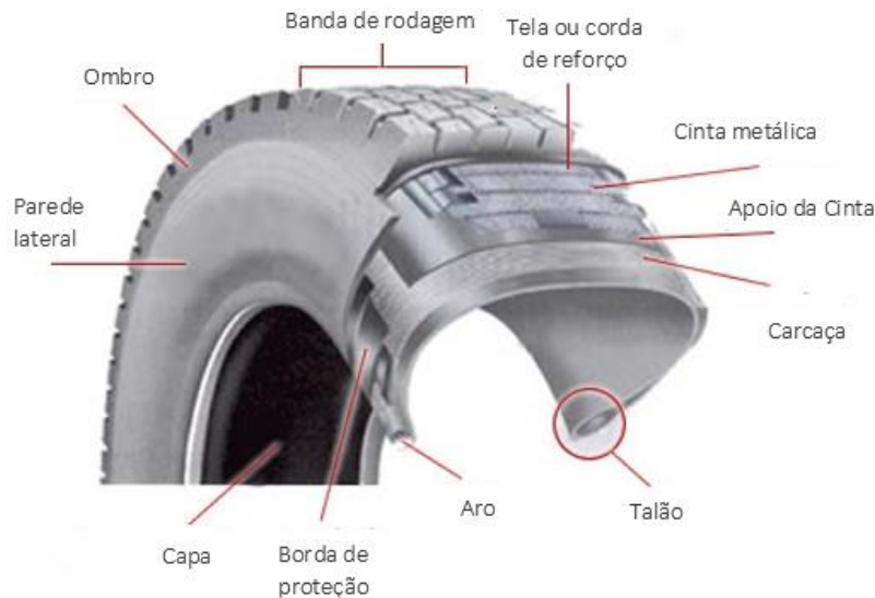
Figura 2.1 Imagem ilustrativa de um pneu respectiva constituição. [4]
