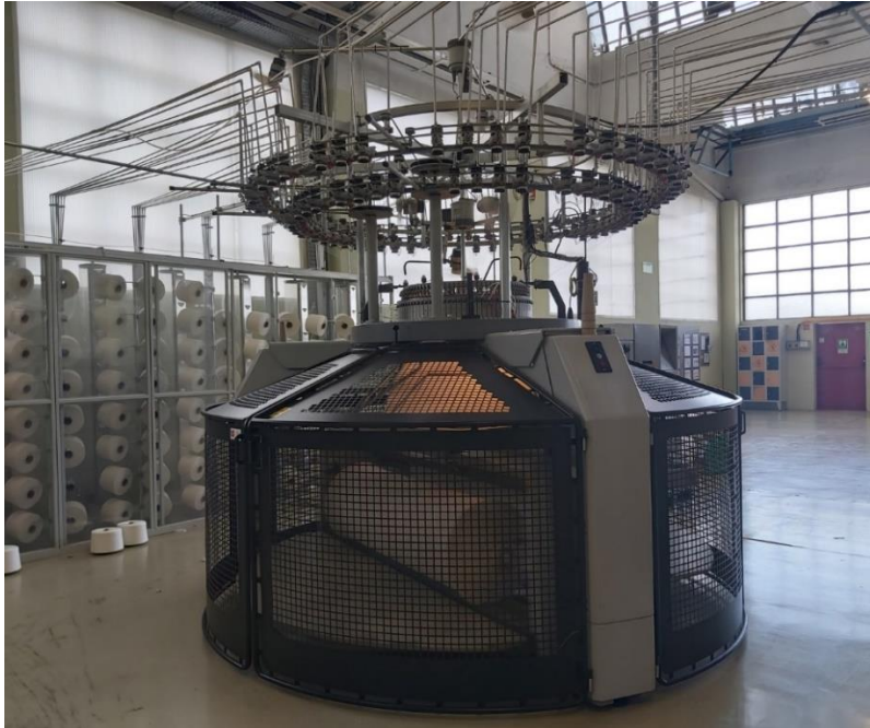
Figura 2.17 Secção de tricotagem para produção de malhas.
