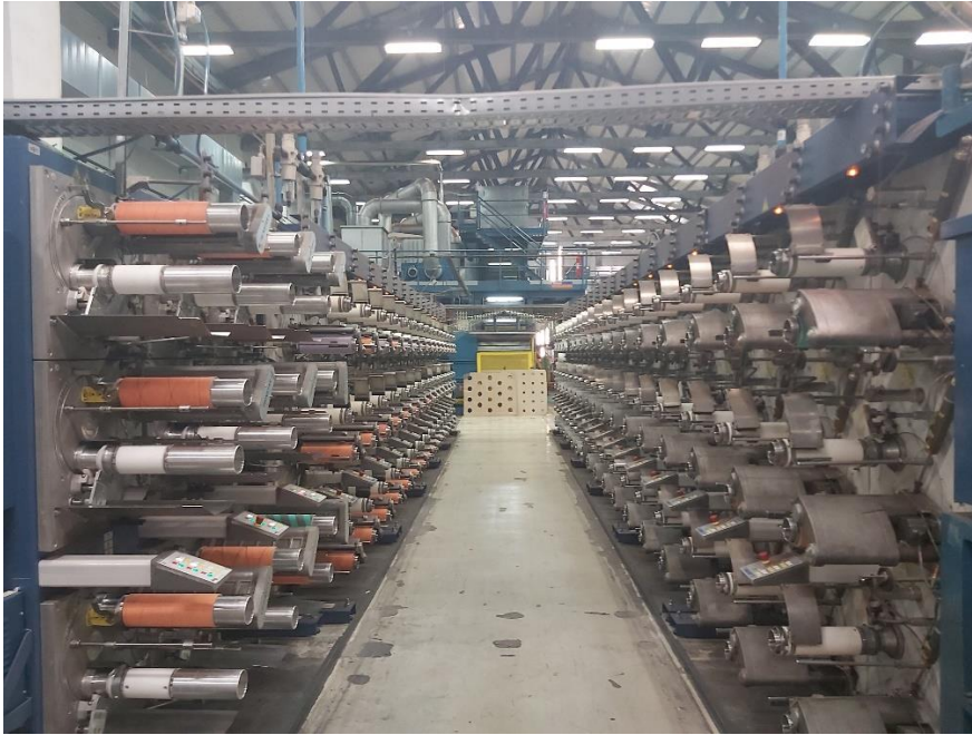
Figura 2.12 Zona de enrolamento da corda da Single End 1.
