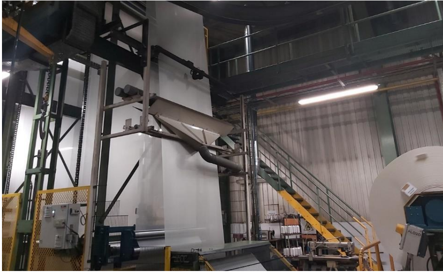
Figura 2.14 Zona de desenrolamento da tela em verde na máquina Zell.
