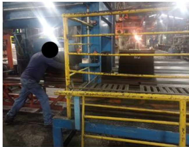
Figura 14 - Transferência do Carro com os moldes para a plataforma de vazamento.
