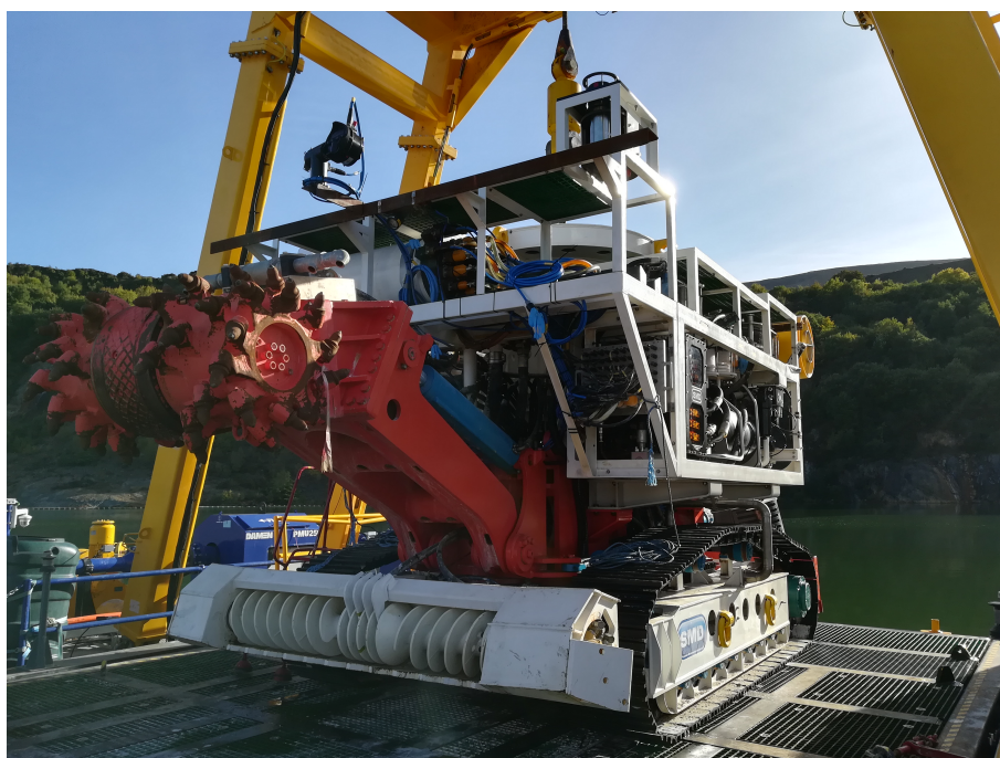
Figura 6.4: MV com sistema turning table pousado na LARV.
