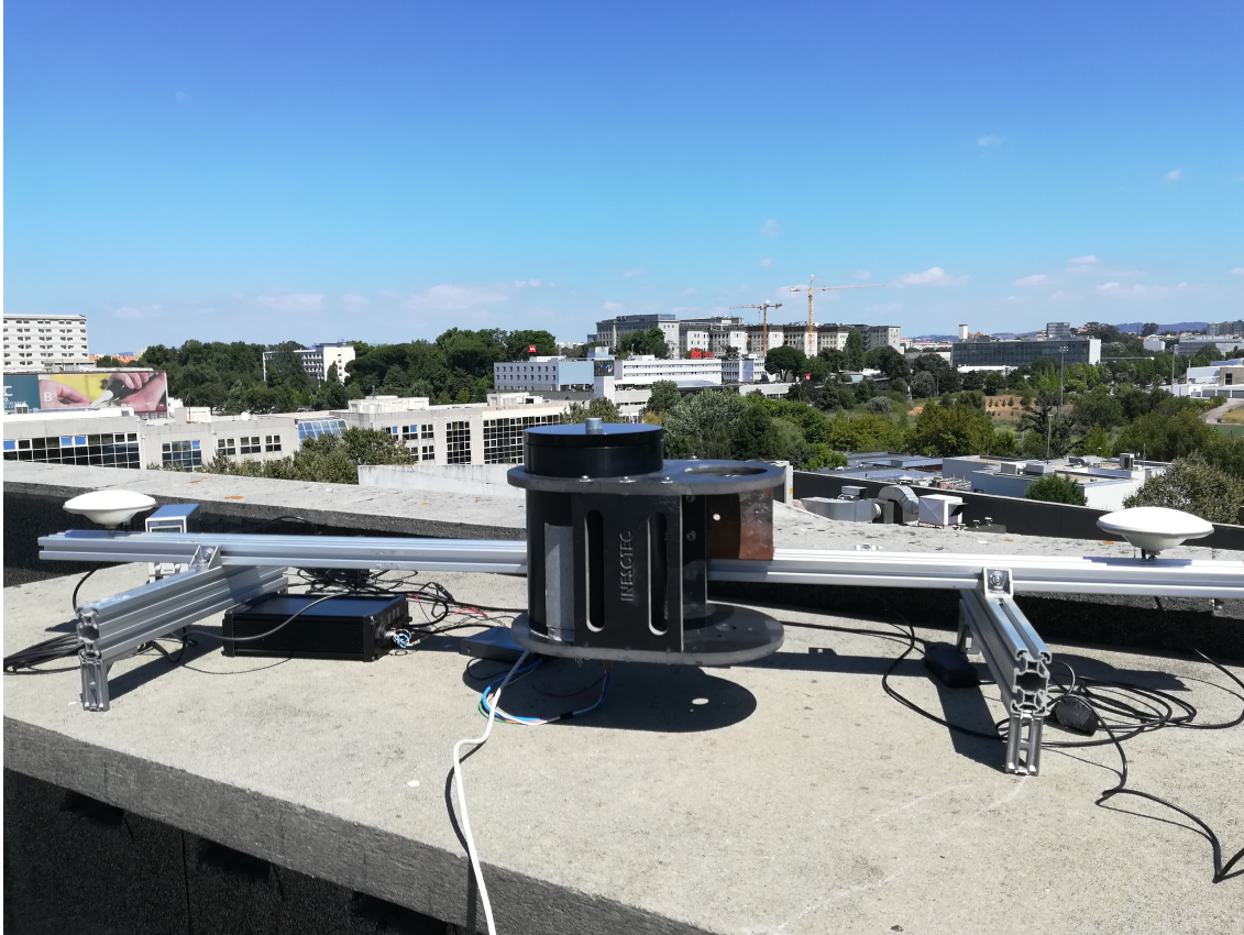
Figura 5.2: Setup experimental com turning table e sistema GPS.
