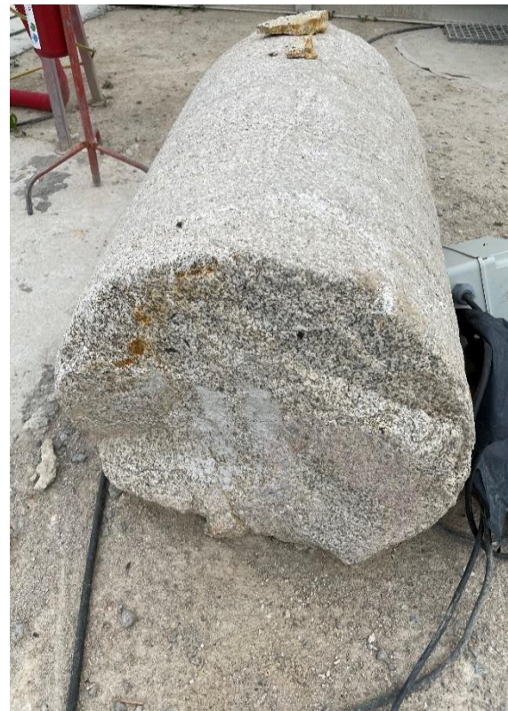
Figura 28 - Testemunho de sondagem com litologia granítica de estado W_3 a W_2 (ISRM, 1981).
