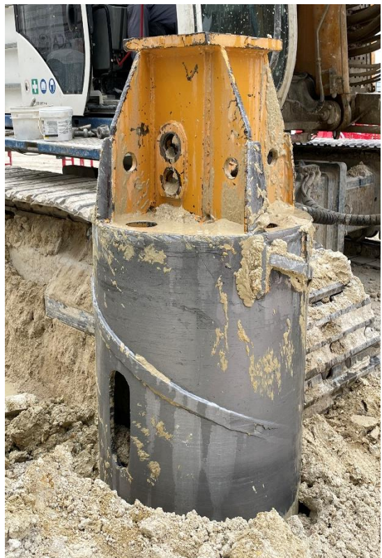
Figura 20 – Ferramenta de corte carotier.
