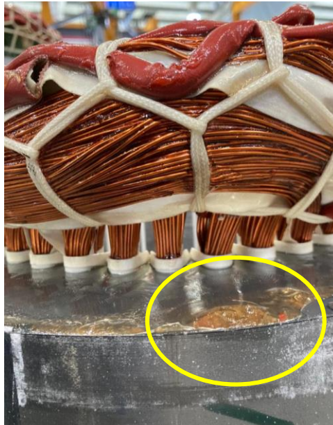
Figura 64 - Problema de resina acumulada na superfície de contacto entre o estator e a ferramenta
