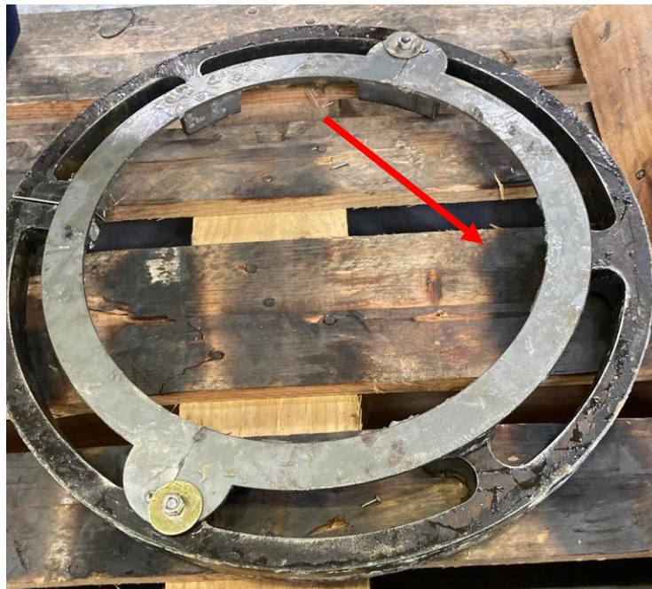
Figura 67 - Empeno da ferramenta protetora de resina
