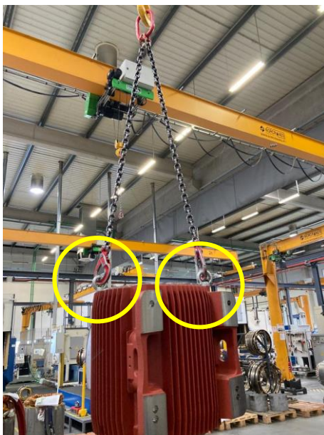
Figura 60 - Função dos olhais - auxílio no transporte da carcaça
