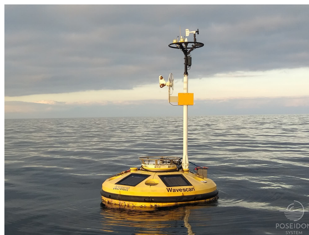
Figura 2.6: Estação Meteorológica numa boia amarrada [22].
