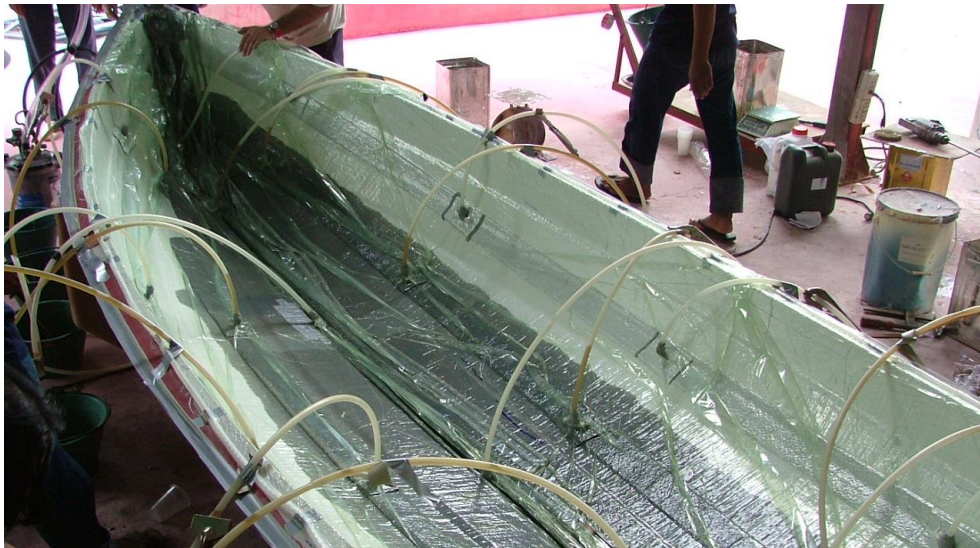
Figura 15 - Produção de um barco de pequenas dimensões em material compósito por infusão a vácuo [27].
