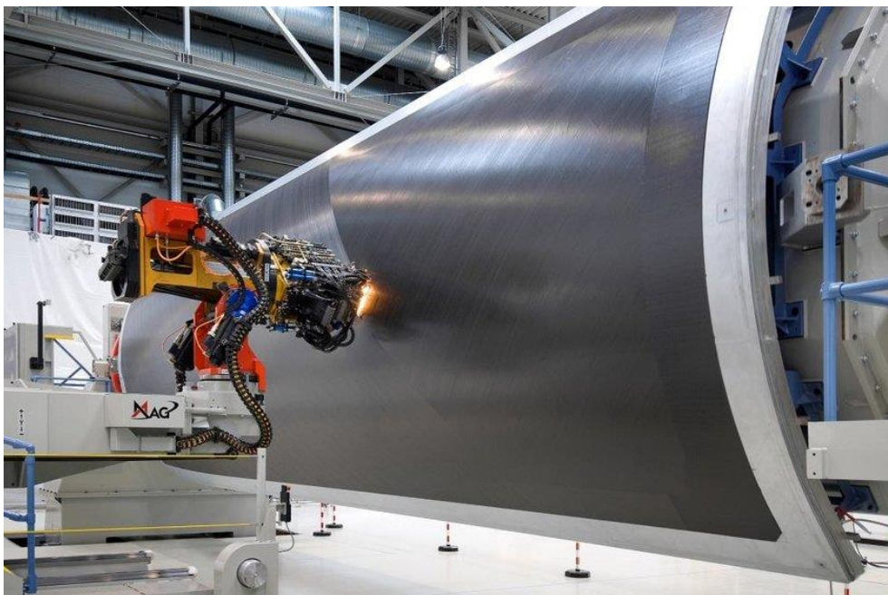
Figura 12 - ATL utilizado na fuselagem do Airbus A350 [20].
