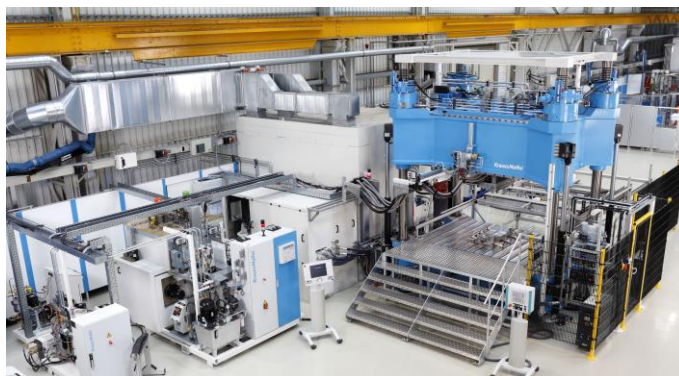
Figura 18 - Equipamento necessário para a realização do processo HP-RTM [31].
