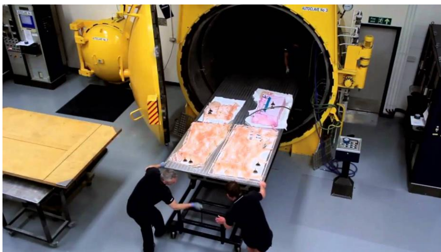
Figura 14-Moldação por autoclave [25].
