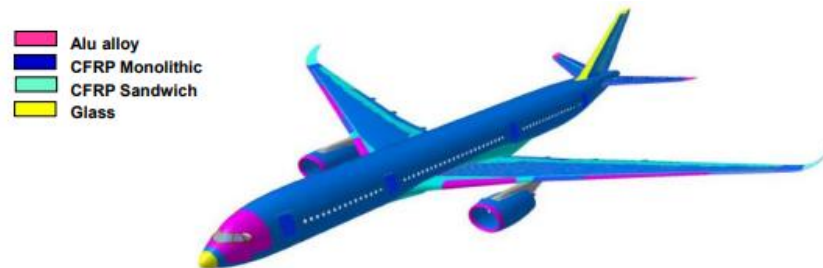
Figura 5 - Airbus A350 XWB composição estrutural [8].
