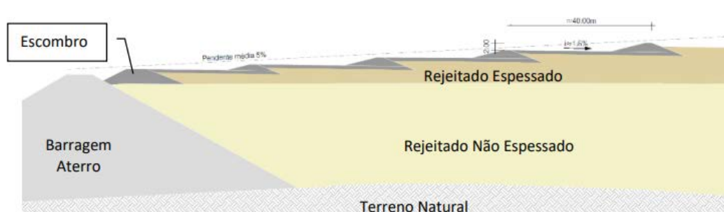
Figura 51 – Corte esquemático do empilhamento vertical na IRCL (Golder, 2021).
