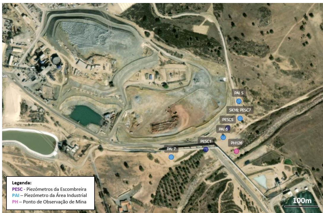
Figura 84 – Localização dos piezômetros a jusante da escombreira.
