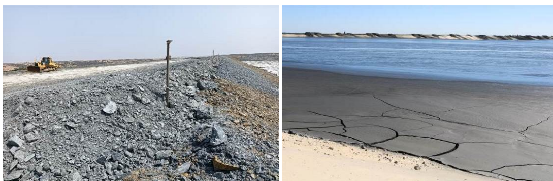
Figura 45 – Resíduos Mineiros – Escombros e Rejeitado.
