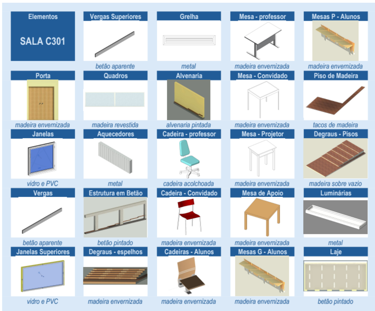
Figura 33 - elementos componentes do modelo BIM da sala C301 (autor).
