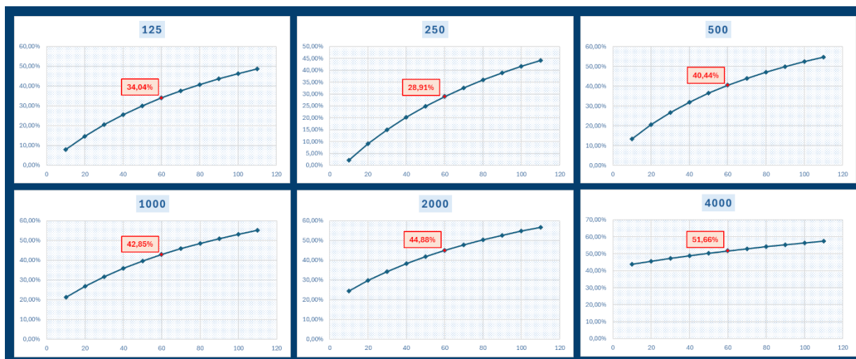
Figura 44 - alteração percentual do TR segundo incremento de alunos para a sala C301 (autor)
