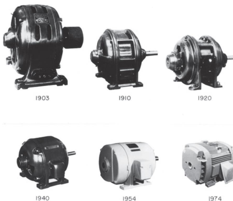
Figura 24 – Evolução do motor de indução de 15 HP [12]
