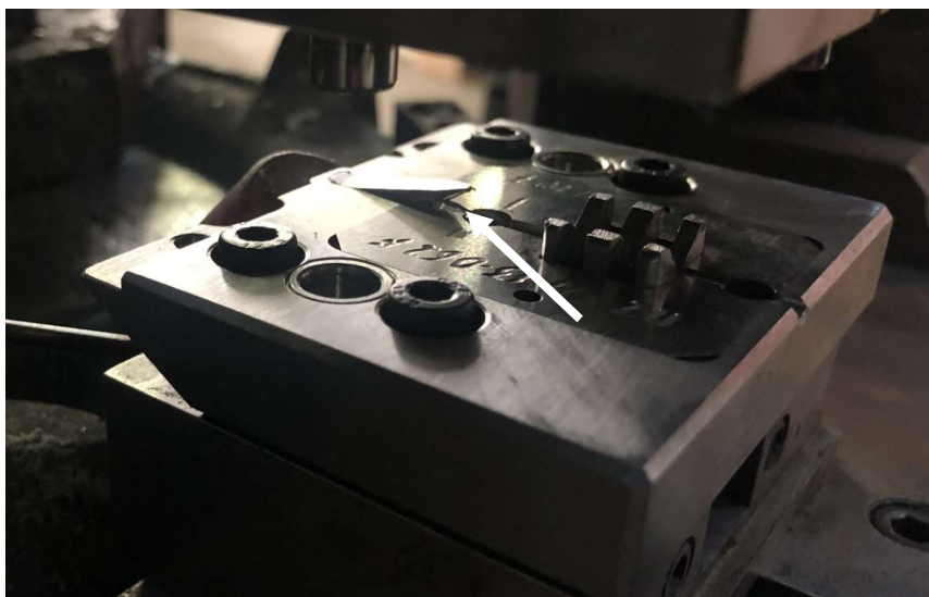
Figura 22- Gito preso no molde devido à contra saída.
