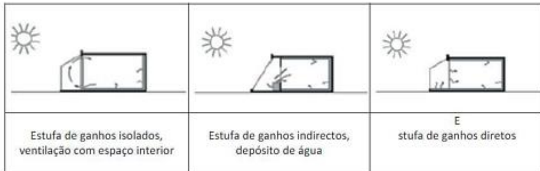
Figura 25 - Sistema passivos de aquecimento por ganho isolado [30]
