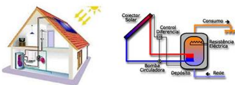
Figura 50 - Sistema elucidativo do sistema circulação forçada [42]
