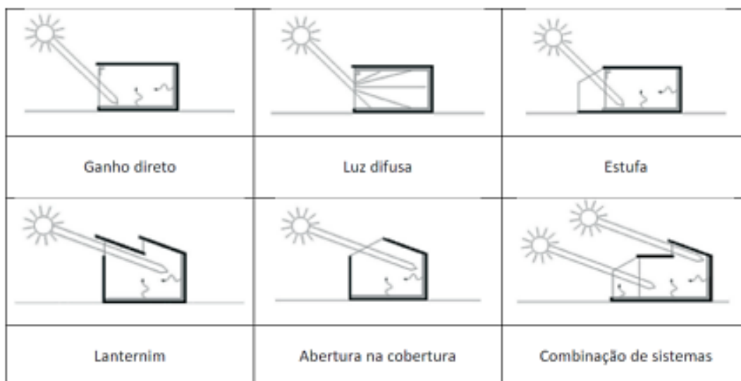
Figura 23 - Sistema passivos de aquecimento por ganho direto [30]
