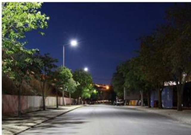
Figura 29 - solução de Led coluna e luminária não normalizada com potência 55w
