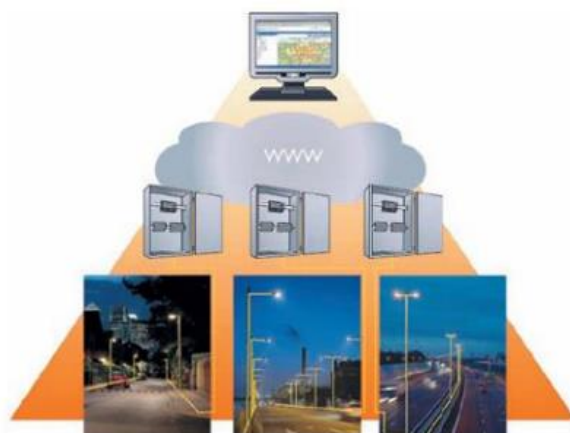
Figura 34 – Sistema de Telegestão ponto a ponto
