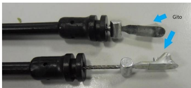
Figura 39- Gito acoplado ao terminal de cabo (2)
