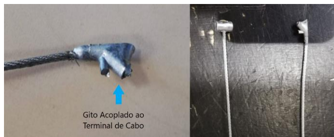
Figura 38- Gito acoplado ao terminal de cabo (1)
