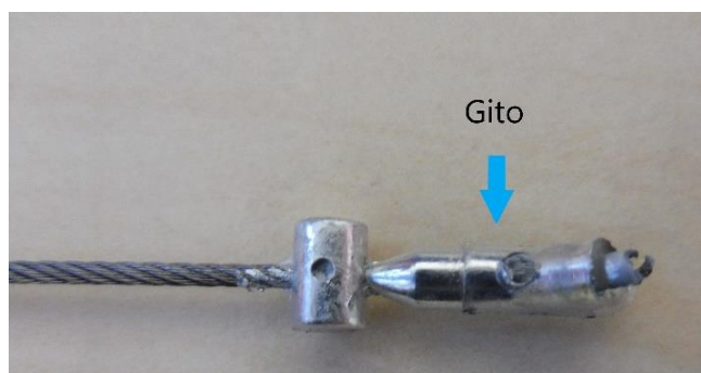
Figura 40- Gito acoplado ao terminal de cabo (3)
