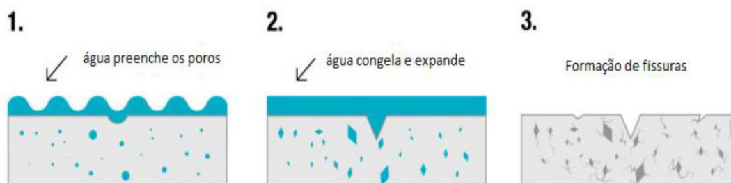
Figura 2-19 - Ciclo gelo-degelo (adaptado de RainGuard, 2017)
