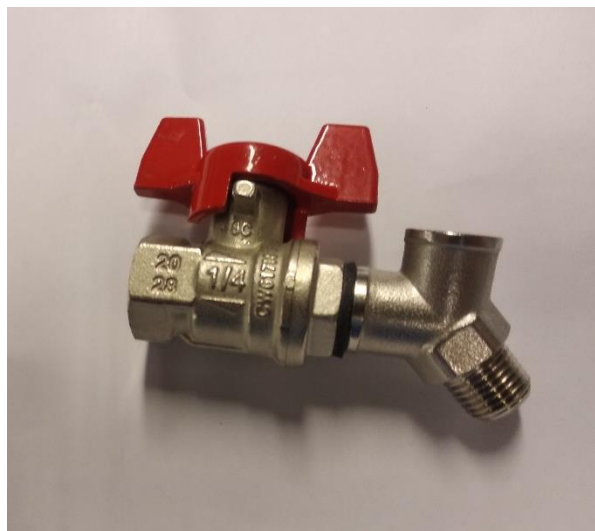
Figura 55 - Ligação do conector Y à válvula de entrada.
