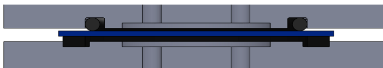
Figura 34 - Um o-rings e uma junta de vedação com diâmetros diferentes.
