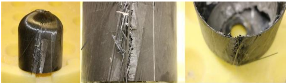
Figura 19 - Tipo de rutura provocada pela pressão interna [57].
