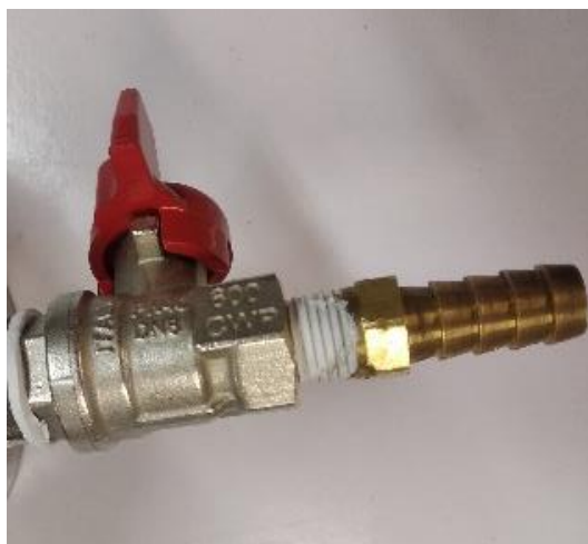
Figura 59 - Ligação da válvula de saída ao adaptador da máquina de vácuo.
