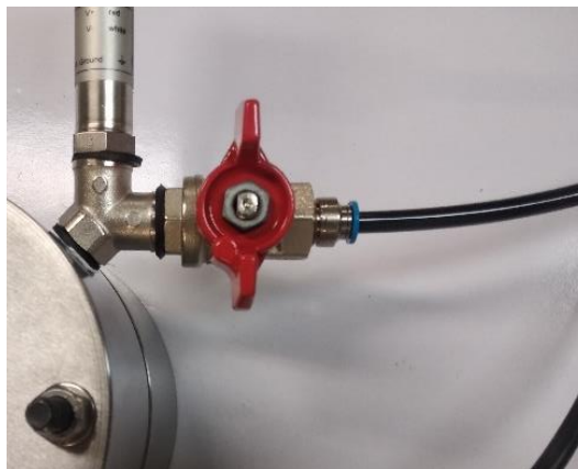
Figura 61 - Ligação da mangueira ao conector de mangueira.
