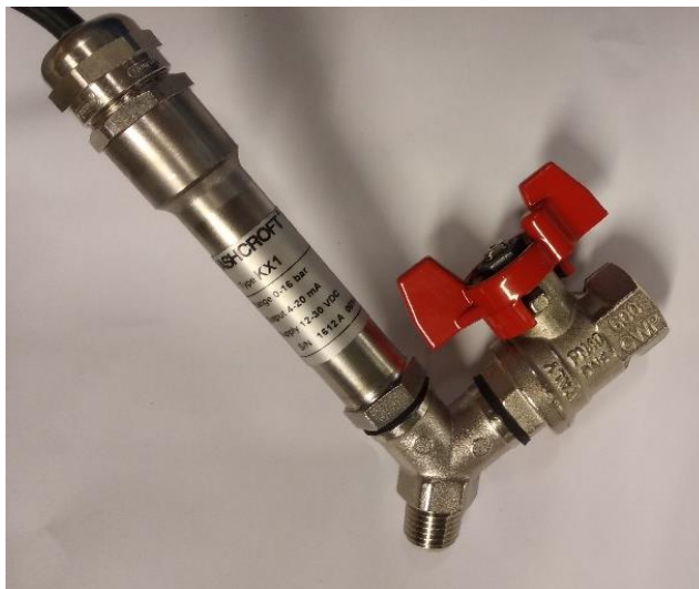
Figura 56 - Ligação do transdutor de 16 bar ao conector Y.
