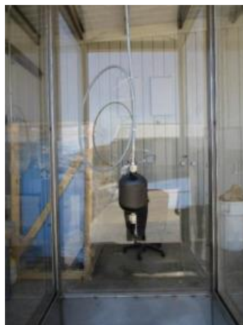
Figura 20 - Compartimento para realizar o ensaio de rutura [57].
