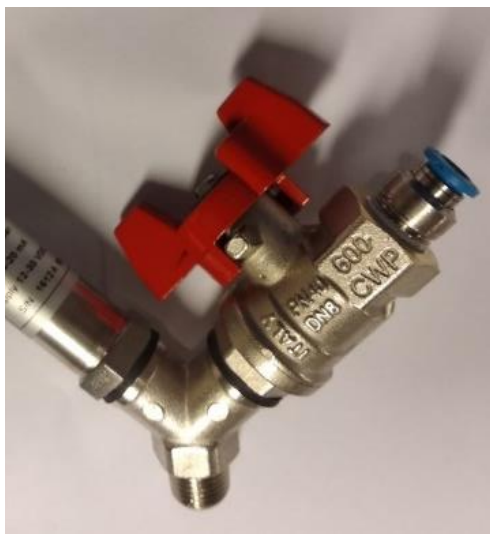
Figura 58 - Ligação do conector da mangueira à válvula de entrada.
