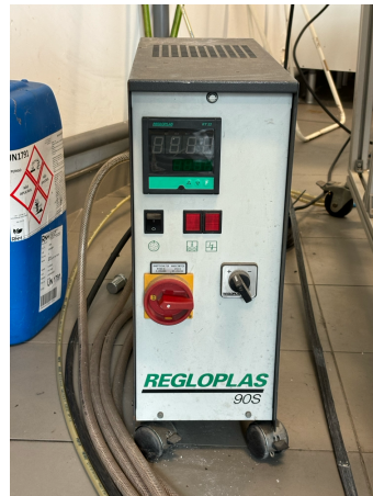
Figura 45- Bomba de recirculação de água
