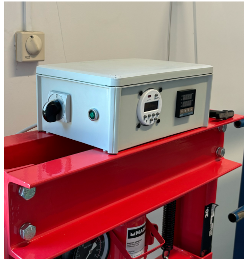
Figura 50- Sistema de controlo e monitorização do aquecimento
