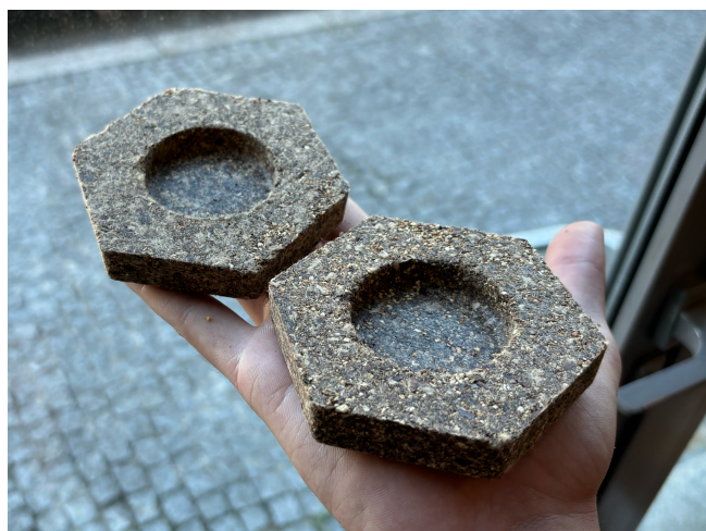
Figura 57- Suporte para velas extraído do molde (sem impermeabilização)
