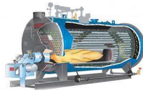
Figura 17 - Esquema representativo de uma caldeira tubular. [20]
